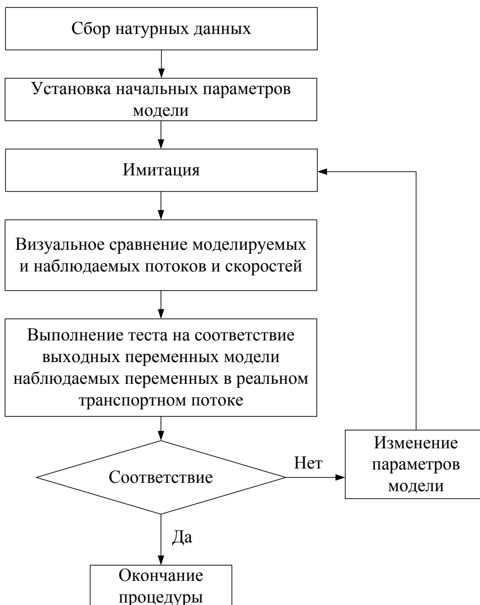
Рис. 4.1 Алгоритм калибровки микроскопических моделей транспортного потока
