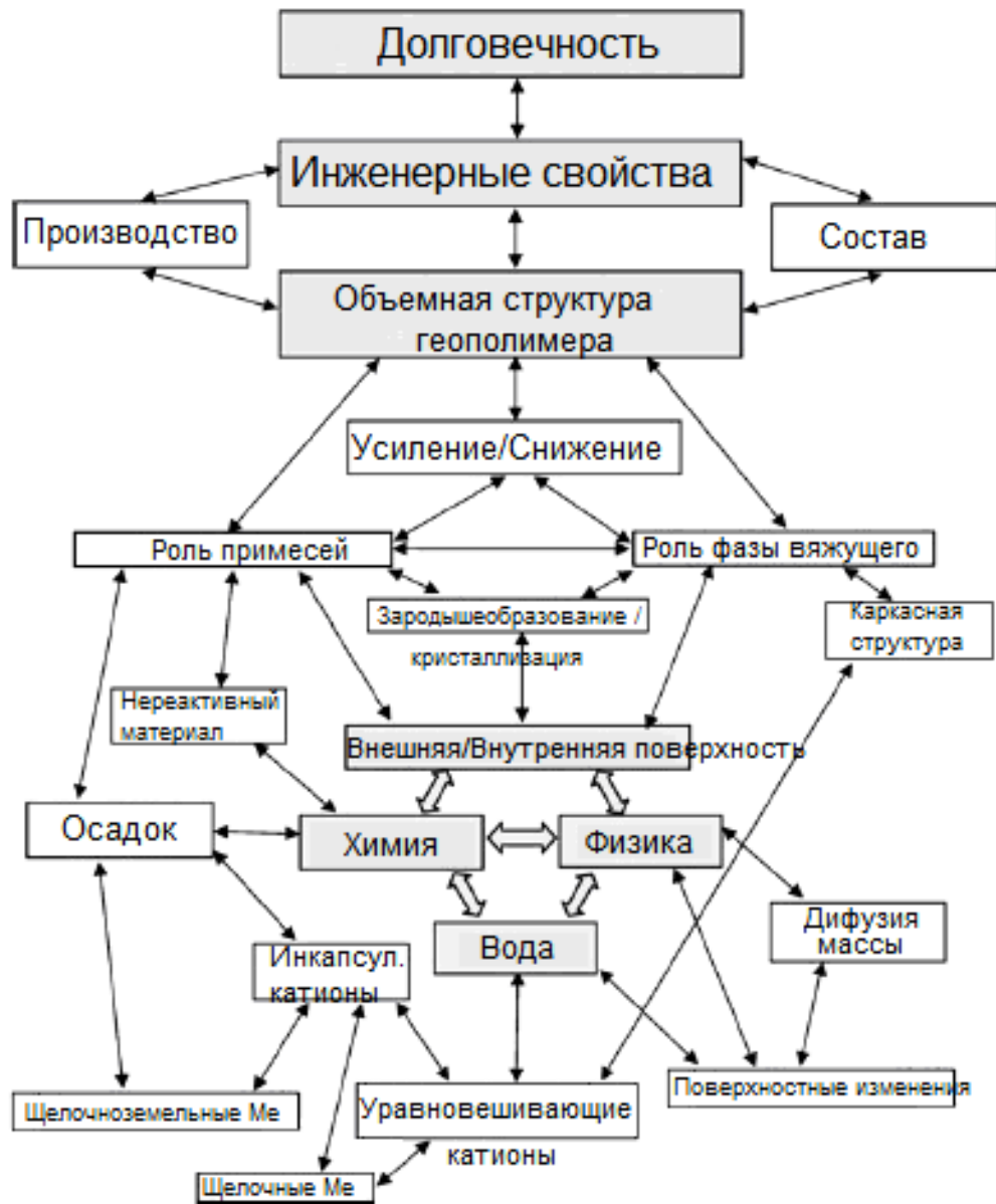
Рис. 3.3. Диаграмма зависимостей между научными и техническими аспектами долговечности геополимеров, по данным [232]
