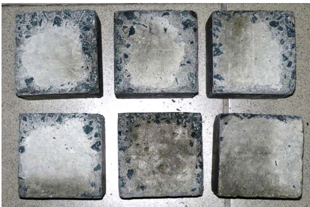
Рис. 3.6. Внешний вид образцов после 206 циклов замораживания-оттаивания
