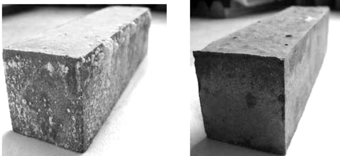
Рис. 3.7. Геополимерные образцы после выдерживания в течение 1,5 года в растворах MgSO_4 и NaCl , по данным [155]
