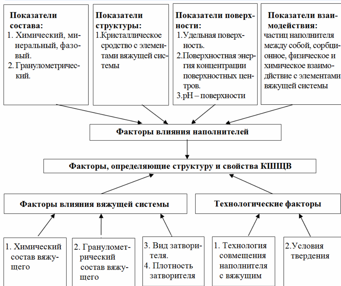
Рис.3.2. Система факторов, определяющих структуру и свойства КШЩВ, по данным Н.Р. Рахимовой [104]
