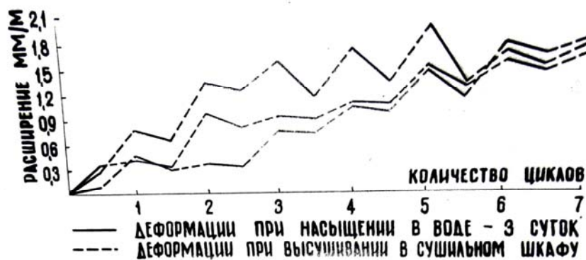
Рис. 9. Наиболее характерное проявление деформаций гранулами керамзита при их переменном насыщении в воде и высушивании
