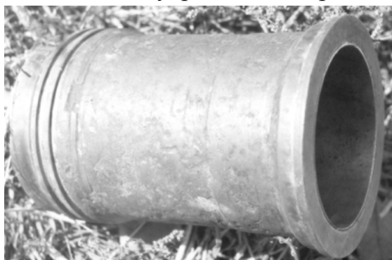
Рис.2.19. Наружная поверхность гильзы после кавитационного изнашивания
