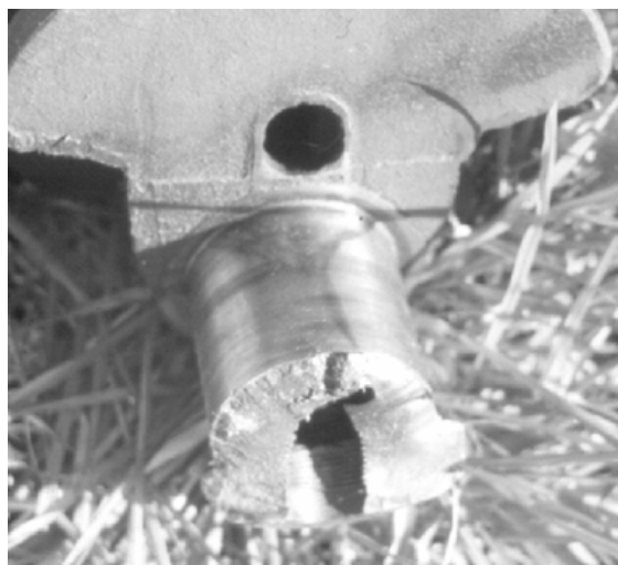
Рис. 2.7. Усталостное разрушение коленчатого вала двигателя
