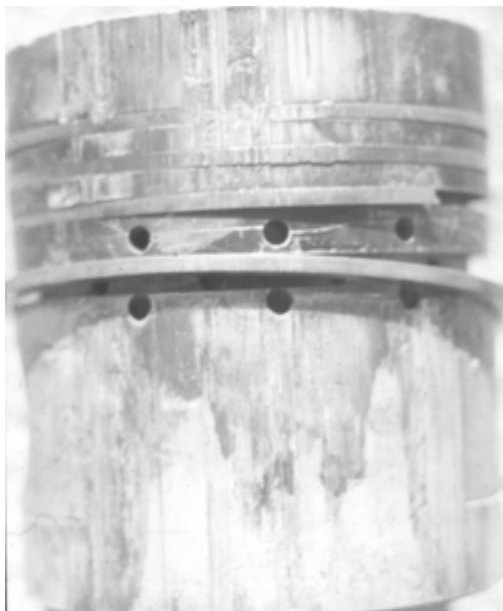
Рис. 2.15. Поршень, подвергшийся изнашиванию при заедании
