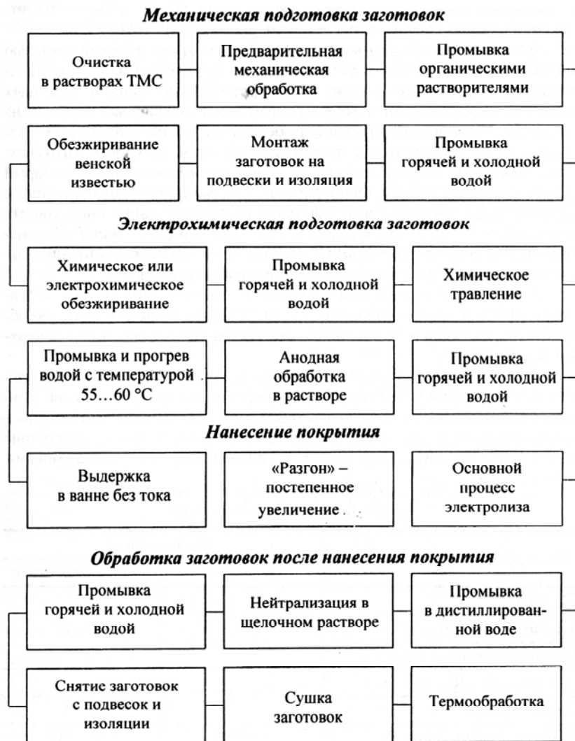
Рис. 5.2. Типовой процесс нанесения гальванических покрытий
