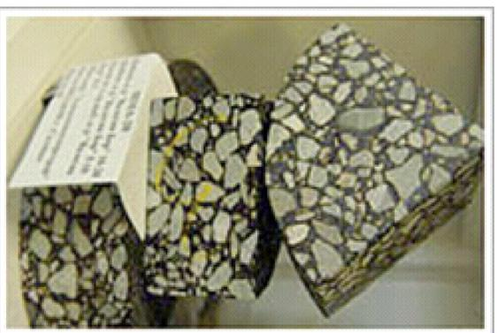
Основные преимущества ЩМА: повышение коэффициента сцепления колес с дорогой, износоустойчивость, в том числе к действию шипованных шин, повышенная водо- и морозостойкость, эрозийная стойкость, большая устойчивость к старению и к усталостным трещинам, снижение уровня шума при движении автомобиля, снижение затрат на содержание и ремонт дорог в 2 - 4 раза.
