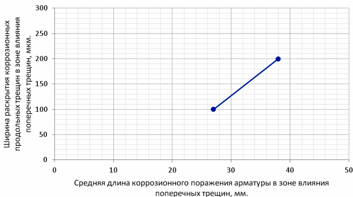
Рис. 2.81. Ширина раскрытия коррозионных продольных трещин a_T^{\text{прод}} на двадцати железобетонных образцах с размерами 1500×200×70 мм, с арматурой диаметром 12 мм класса А-III, при толщине защитного слоя бетона с \delta_{з.с.б} = 25 мм и классе бетона В=40, в зависимости от средней длины коррозионного поражения арматуры \ell_{кор}^{\text{сред}} в зоне влияния поперечных трещин с a_{crc} = 0,1 \div 0,25 мм, с учетом средней глубины коррозии арматуры, при нижней функциональной прямой (рис. 1.26), при увеличении толщины продуктов коррозии стальной арматуры в 1,5 раза, по сравнению с металлом арматуры, при действии переменной ступенчатой повторной и постоянной изгибающей нагрузки
