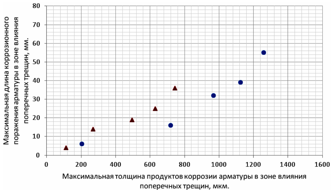
Рис. 2.38. Максимальная длина коррозии арматуры диаметром 12 мм класса А-III ( l_{кор}^{max} ) в зоне влияния поперечных трещин на двадцати железобетонных образцах с размерами 1500×200×70 мм, при толщине защитного слоя бетона \delta_{з.с.б} = 25 мм и классе бетона В=40, в зависимости от максимальной толщины продуктов коррозионного поражения арматуры ( \delta_{п.к}^{max} ) в поперечных трещинах бетона с a_{crc} = 0,1 \div 0,25 мм, с учётом максимальной глубины коррозионного поражения арматуры, при увеличении толщины продуктов коррозии стальной арматуры в 2,25 раза, по сравнению с металлом арматуры, в условиях воздействия переменной ступенчатой повторной и постоянной изгибающей нагрузки Условные обозначения: окружность – переменная изгибающая нагрузка, значения ширины раскрытия поперечных трещин с координатами: a_{crc} = 0,05 мм (203;6), a_{crc} = 0,10 мм (720; 16), a_{crc} = 0,15 мм (968; 32), a_{crc} = 0,20 мм (125;39), a_{crc} = 0,25 мм (1260;55); треугольник – максимальная изгибающая нагрузка, значения ширины раскрытия поперечных трещин с координатами: a_{crc} = 0,05 мм (203;6), a_{crc} = 0,10 мм (270; 14), a_{crc} = 0,15 мм (495; 19), a_{crc} = 0,20 мм (630;25), a_{crc} = 0,25 мм (743;36).
