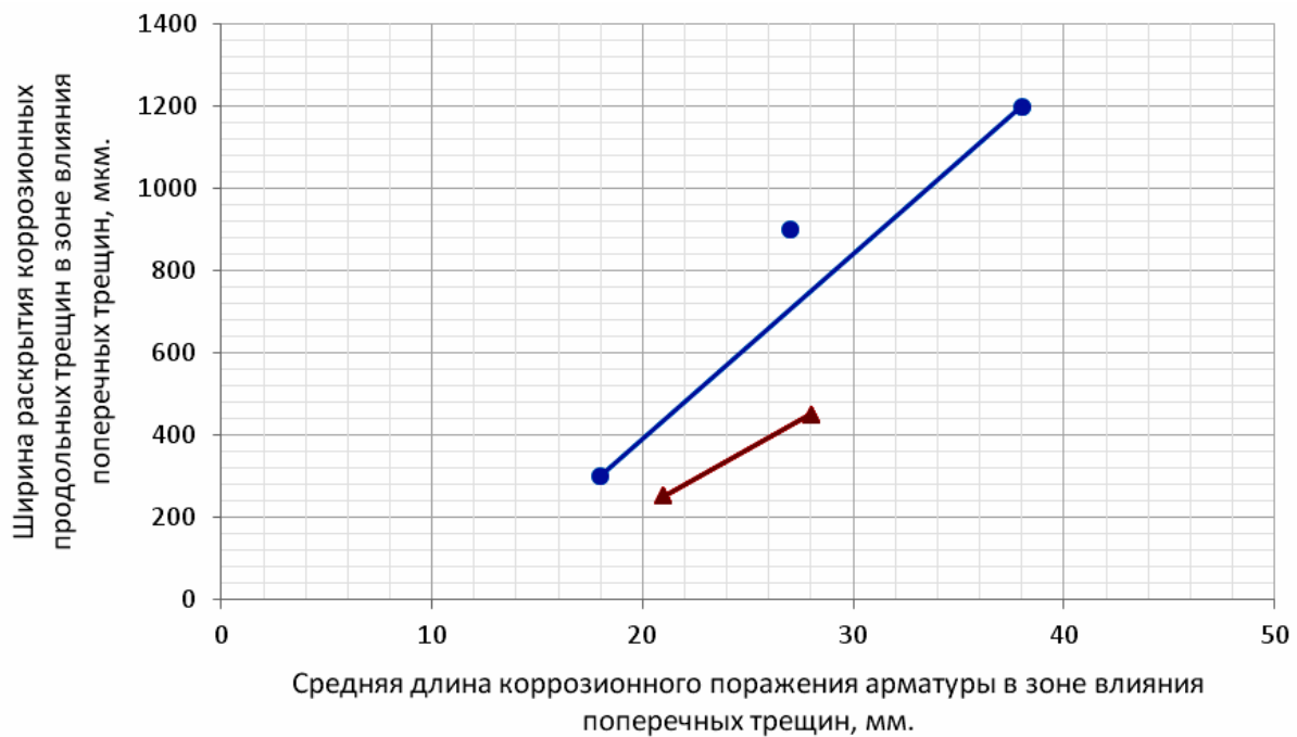
Рис. 2.59. Ширина раскрытия коррозионных продольных трещин a_T^{\text{прод}} в зоне влияния поперечных трещин на двадцати железобетонных образцах с размерами 1500 \times 200 \times 70 мм, с арматурой диаметром 12 мм класса А-III, при толщине защитного слоя бетона с \delta_{з.с.б} = 25 мм и классе бетона В=40, в зависимости от средней длины коррозионного поражения арматуры \ell_{\text{кор}}^{\text{сред}} в зоне влияния поперечных трещин с a_{\text{crc}} = 0,1 \div 0,25 мм, с учетом средней глубины коррозии арматуры \delta_{\text{кор}}^{\text{сред}} , при верхней функциональной прямой (рис. 1.26), при 2,25-кратном увеличении толщины продуктов коррозии арматурной стали, в условиях воздействия переменной ступенчатой повторной и постоянной изгибающей нагрузки
