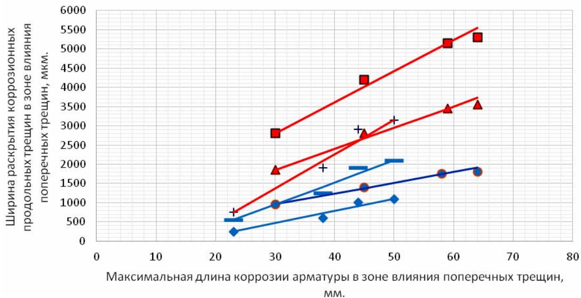
Рис.2.99. Ширина раскрытия коррозионных продольных трещин a_T^{\text{прод}} на поверхности защитного слоя бетона с \delta_{з.с.б} = 25 мм опытных железобетонных образцов с размерами 2000 \times 200 \times 70 мм в зоне влияния поперечных трещин, в зависимости от максимальной длины коррозии арматуры диаметром 14 мм класса А-III \ell_{\text{кор}}^{\text{max}} в зоне влияния поперечных трещин с a_{\text{cpc}} = 0,1 \div 0,35 мм, с учетом максимальной глубины коррозионного поражения арматуры и трехкратного увеличения толщины продуктов коррозии арматурной стали, по сравнению с металлом арматуры, при нижней, средней и верхней функциональных прямых согласно рис. 2.96–2.98 и полученные уравнения регрессии, при действии переменной ступенчатой повторной и постоянной изгибающей нагрузки
