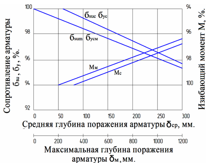
Рис. 1.21. Зависимости изменения величины несущей способности железобетонных балок и физико-механических характеристик рабочей арматуры класса А-III Ø14 мм от глубины коррозионного поражения арматуры: \sigma_{su} и \sigma_y – соответственно среднее временное сопротивление и физический предел текучести арматуры; M_c – изгибающий момент для постоянного нагружения; M_m – изгибающий момент для переменной нагрузки; индексы C и M – соответственно постоянное и переменное нагружение; \delta_{ср} и \delta_m – соответственно средняя и максимальная глубина коррозионного поражения арматуры
