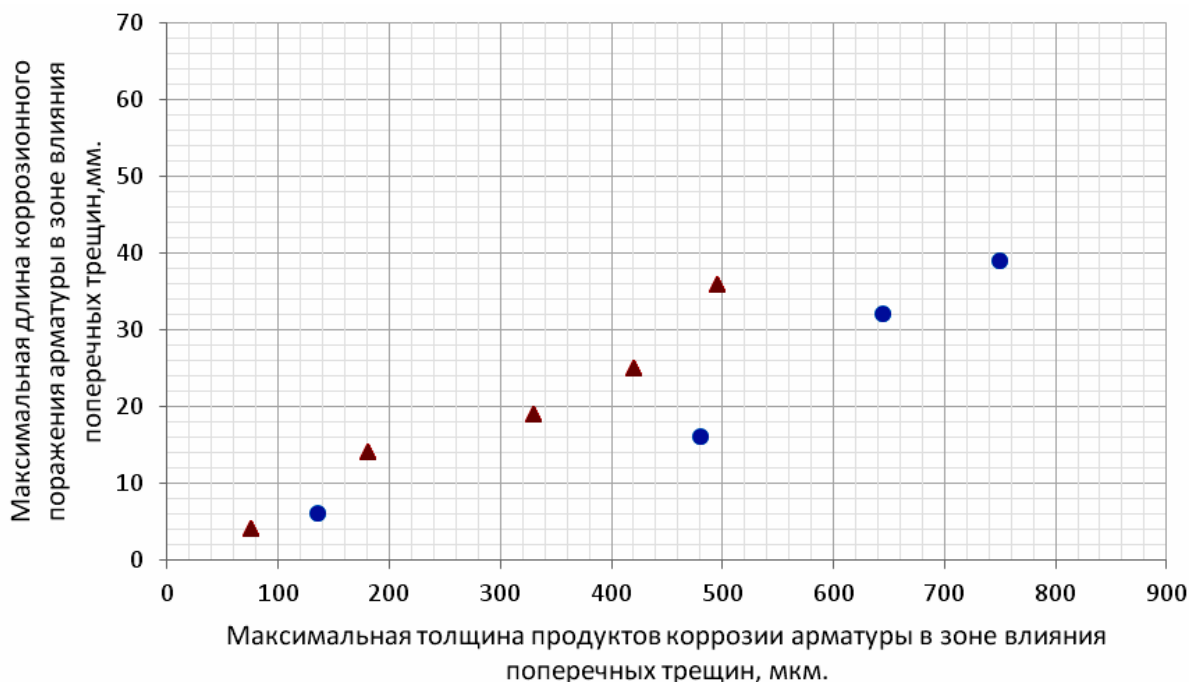
Рис. 2.62. Максимальная длина коррозии арматуры в зоне влияния поперечных трещин диаметром 12 мм класса А-III l_{кор}^{max} на двадцати железобетонных образцах с размерами 1500×200×70 мм, при толщине защитного слоя бетона \delta_{з.с.б} = 25 мм и классе бетона В=40, в поперечных трещинах бетона с a_{crc} = 0,1 \div 0,25 мм, в зависимости от максимальной толщины продуктов коррозионного поражения арматуры \delta_{п.к}^{max} , при увеличении их толщины в 1,5 раза, по сравнению с металлом арматуры, в условиях воздействия переменной ступенчатой повторной и постоянной изгибающей нагрузки Условные обозначения: окружность – переменная изгибающая нагрузка, значения ширины раскрытия поперечных трещин с координатами: a_{crc} = 0,05 мм (135;6), a_{crc} = 0,10 мм (180;14), a_{crc} = 0,15 мм (330;19), a_{crc} = 0,20 мм (420;25), a_{crc} = 0,25 мм (495;36); треугольник – постоянная изгибающая нагрузка, значения ширины раскрытия поперечных трещин с координатами: a_{crc} = 0,05 мм (135;4), a_{crc} = 0,10 мм (180;14), a_{crc} = 0,15 мм (330;19), a_{crc} = 0,20 мм (420;25), a_{crc} = 0,25 мм (495;36). Индекс п.к – продукты коррозии.
