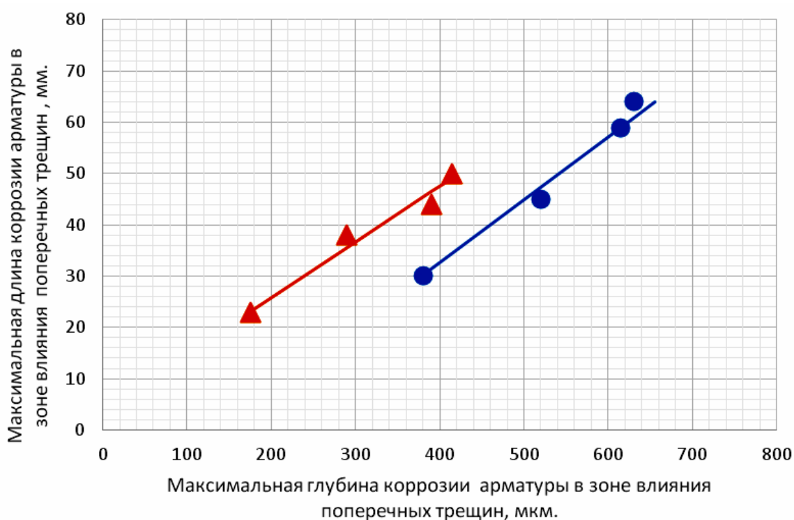
Рис.2.88. Максимальная длина коррозии арматуры диаметром 14 мм класса А-III в железобетонных образцах с размерами 2000×200×70 мм, при толщине защитного слоя бетона \delta_{з.с.б} = 25 мм, в зависимости от максимальной глубины коррозии металла арматуры в поперечных трещинах с a_{crc} = 0,1 \div 0,35 мм, при действии переменной ступенчатой повторной и постоянной изгибающей нагрузки
