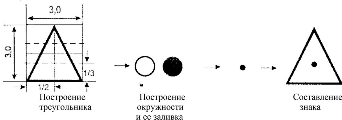
**Пример** построения условного знака астрономического пункта размером 3,0×3,0 мм. Условный знак может быть построен двумя способами: традиционным и с использованием готовых геометрических форм программного пакета.
