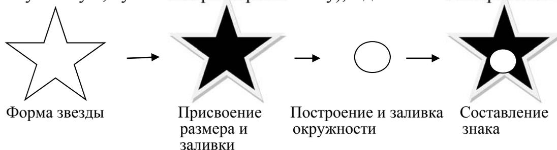
Пример построения условного знака (размером 2,0 x 2,0 мм) пункта геодезической сети сгущения, закрепленного на местности центром и расположенного на кургане.
