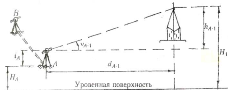
Рис. 19. Схема передачи отметки с опорной на пространственную точку
