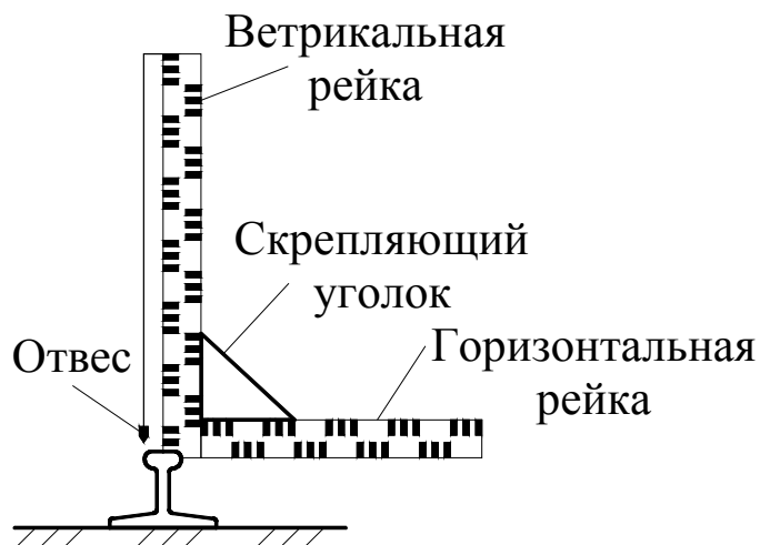
Рис.60. Схема установки рейки
