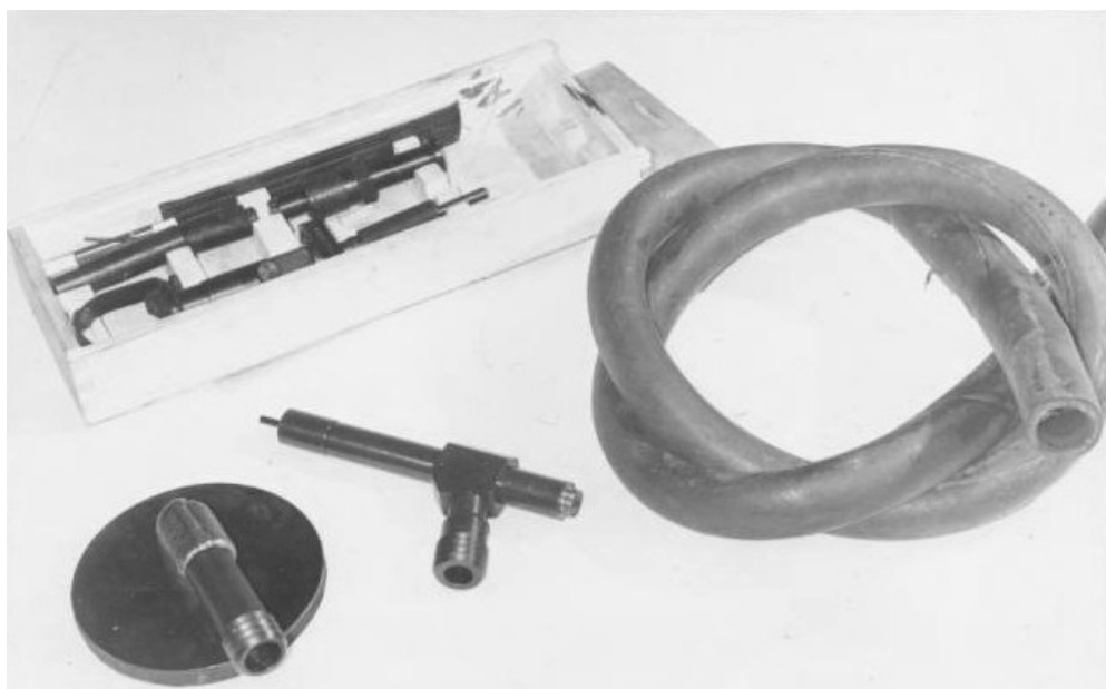
Рис. 31. Общий вид устройств: а) КИ-13933-ГОСНИТИ; б) КИ-13933М-ГОСНИТИ: 1 – КИ-139933-ГОСНИТИ; 2 – заслонка; 3 – наконечник; 4 – шланг
