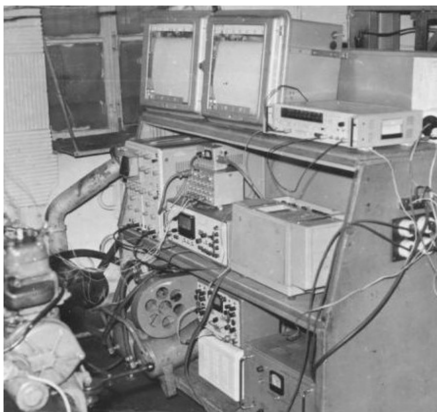
Рис.7. Экспериментальная установка для исследований инерционного и вакуумметрического методов диагностирования шатунных подшипников: а – стенд электротормозной; б – измерительная аппаратура
