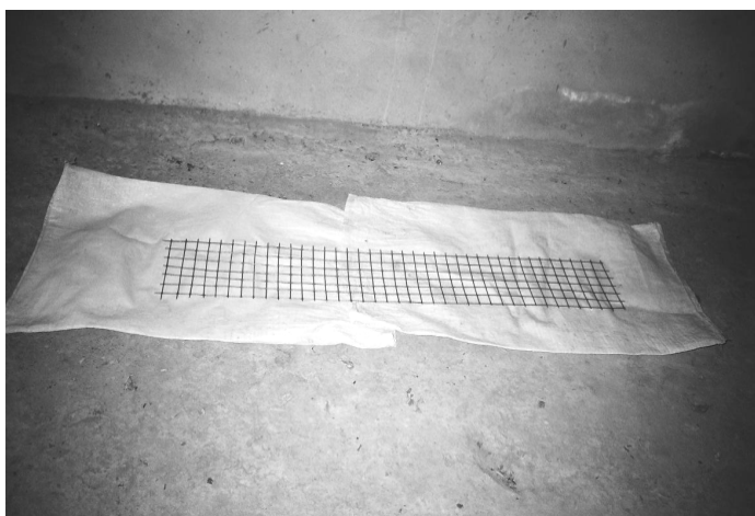
Рис. 4.2. Сварная сетка С-1
