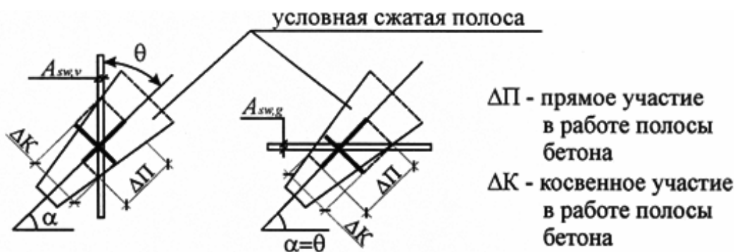
Рис.41. Схема участия поперечной арматуры в работе наклонной сжатой полосы: а – вертикальных хомутов; б – горизонтальных хомутов
