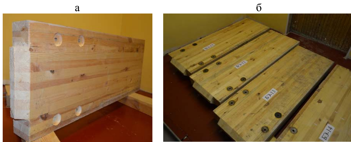
Рис. 4.23. Общий вид балочных элементов БЭ-11, БЭ-12, БЭ-13, БЭ-14, подготовленных для испытания: а – с отверстиями и гнёздами под шайбы; б – с вклеенными шайбами
