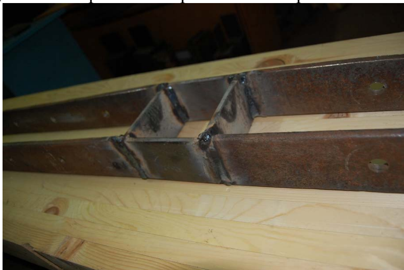
Рис. 4.10. Соединительный сварной элемент для стыка клеёной балки
