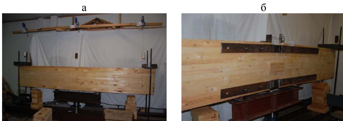
Рис. 4.13. Испытания клеёных деревянных балок: а – испытание цельной балки, б – испытание жёсткого узла балки с применением вклеенных стальных шайб
