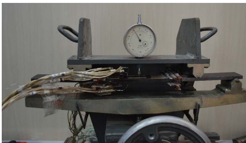
Рис. 4.28. Общий вид установки для тарирования тензорезисторов
