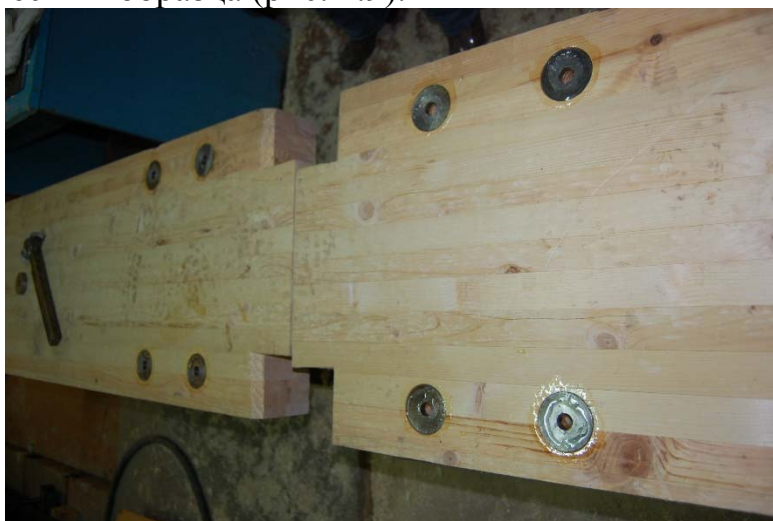
Рис. 4.9. Образцы стыка клеёной балки с вклеенными шайбами
