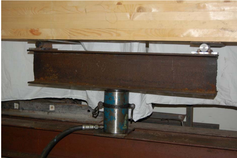
Рис. 4.11. Схема приложения нагрузки на клеёную балку
