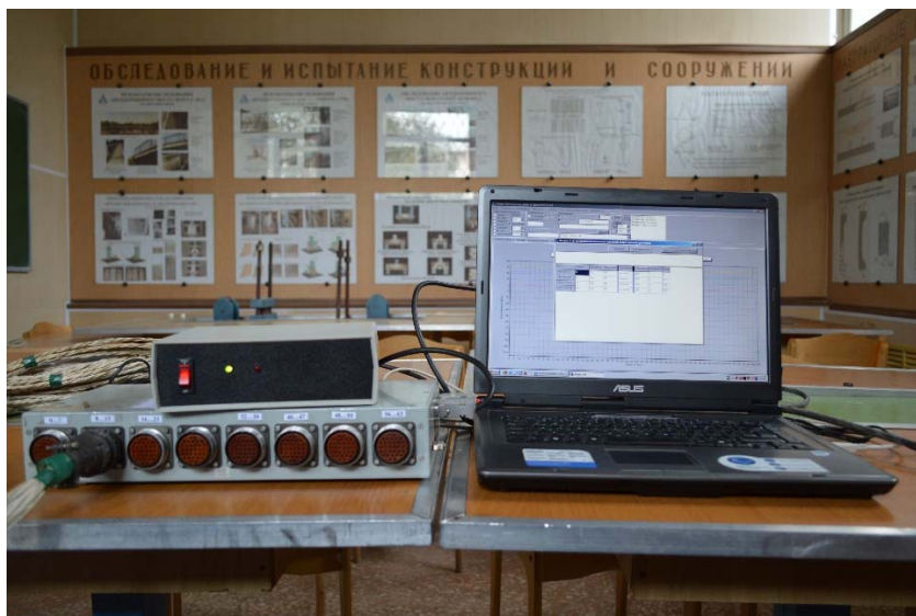
Рис. 4.27. Общий вид тензометрической системы ММТС.64-01
