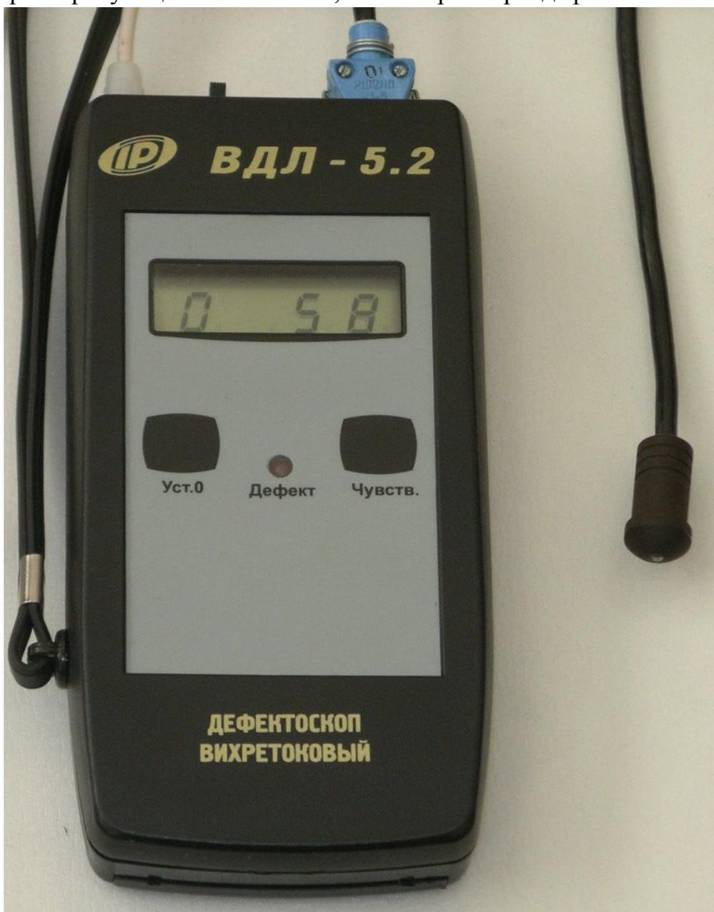
Рис. 14 Внешний вид прибора ВДЛ-5.2
