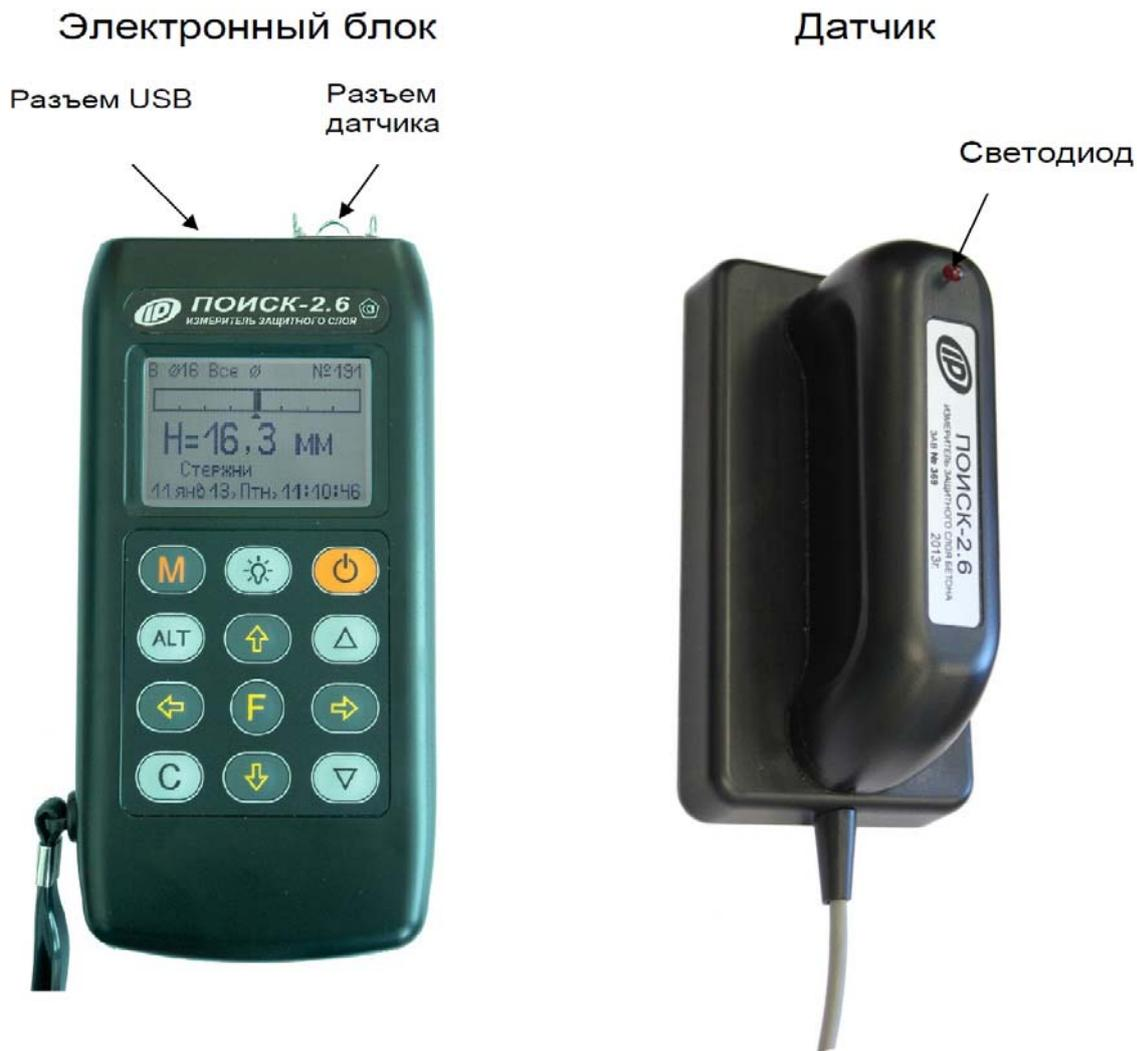
Рис. 11. Общий вид прибора поиск
