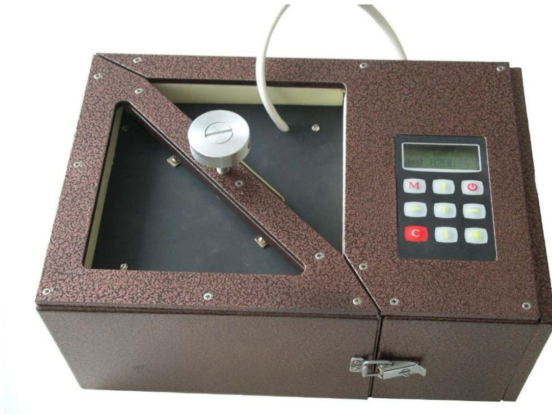
Рис. 18. Внешний вид измерителя теплопроводности
