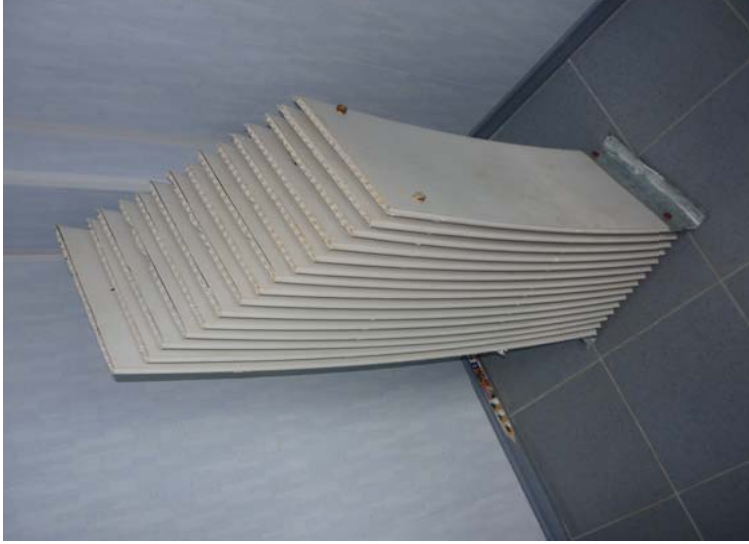
Рис. 3.15. Разработанная конструкция радиатори с повышенной охлаждающей мощностью: а – общий вид; б – насадка (контактный узел); в – теплообменник
