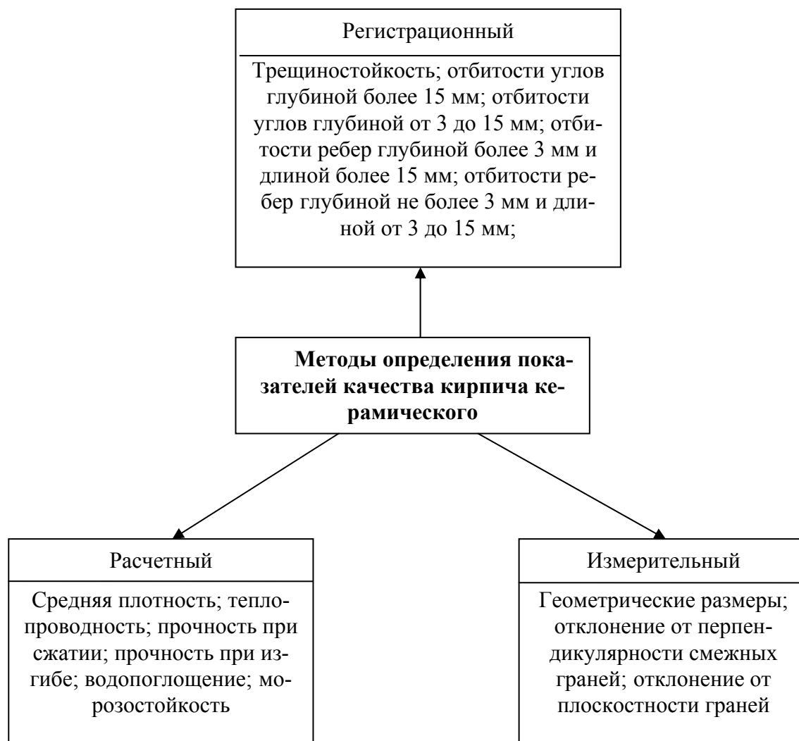
Рис. 2. Методы определения показателей качества кирпича керамического
