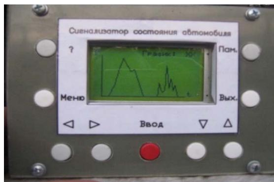
Рисунок 3.11 – Внутренний и внешний вид встроенной системы диагностирования
