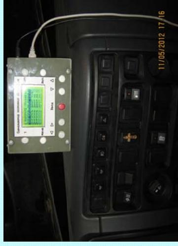
Подключение и общий внешний вид встроенной системы диагностирования
