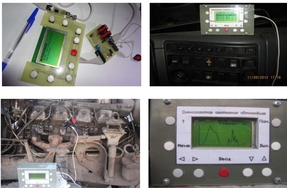
Рис. 7 Встроенная система диагностирования
