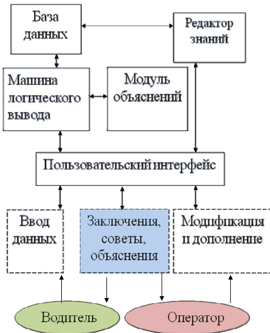
Рис. 5.1. Логическая схема программы
