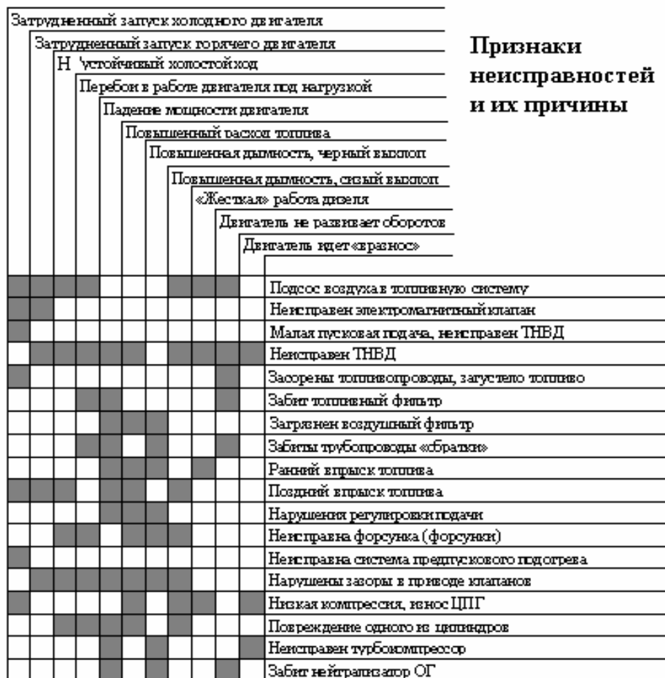
Рис.1.1. Признаки неисправностей дизельных двигателей
