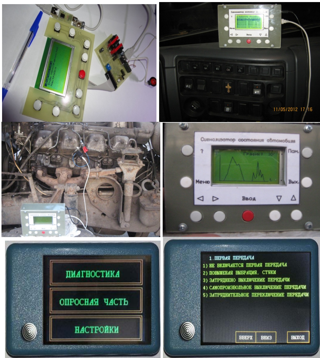
Рис. 5.11. Внутренний и внешний вид встроенных систем диагностирования
