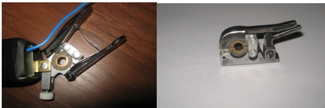
Рис. 5.10. Датчики давления топлива с пружинным и эксцентриковым зажимом
