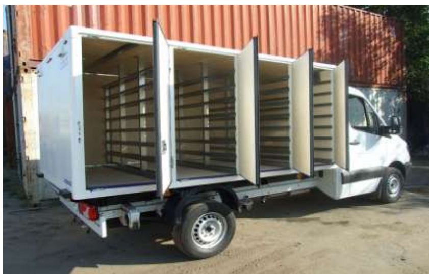
Рис. 2.4. Специально оборудованный транспорт ОАО «Сервис» для перевозки хлебобулочных изделий
