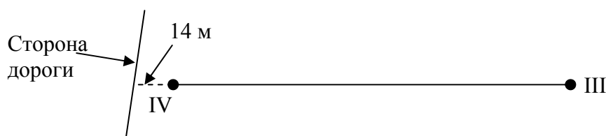
Рис.5. Схема определения положения стороны дороги способом створов
