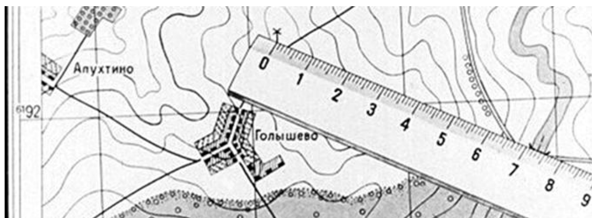
Рис. 5. Определить по карте расстояние между точками местности с помощью линейки
