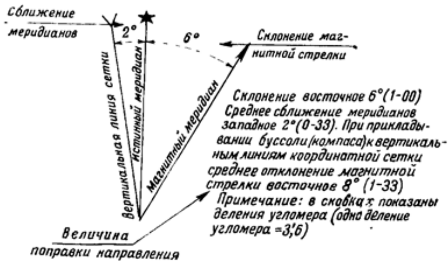
Рис. 19. Схема магнитного склонения, сближения меридианов и поправка направления
