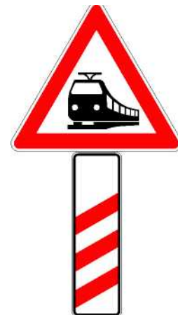
dreistreifige Bake (rechts) vor unbeschränktem Bahnübergang etwa 80 m vor dem Bahnübergang
