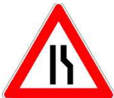
Einseitig (rechts) verengte Fahrbahn
