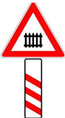
dreistreifige Bake (links) vor beschränktem Bahnübergang etwa 160 m vor dem Bahnübergang
