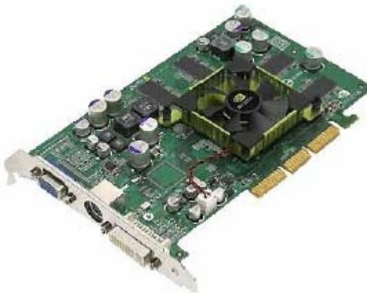
Die wichtigsten Komponenten moderner Grafikkarten sind: GPU, Video-RAM, RAMDAC sowie die Anschlüsse für externe Geräte. Sie dient auch für Dekodierung von komprimierten Videodaten (MPEG). Da heutige Grafikkarten quasi eigene Computer sind, wird die CPU auf den Mainboard stark entlastet. Grafikkarten benutzen als Speicher GDDR, das sind Speicher nach DDR-SDRAM-Standard die mittels geringer Zugriffszeiten auf hohe Taktfrequenzen optimiert wurden.
