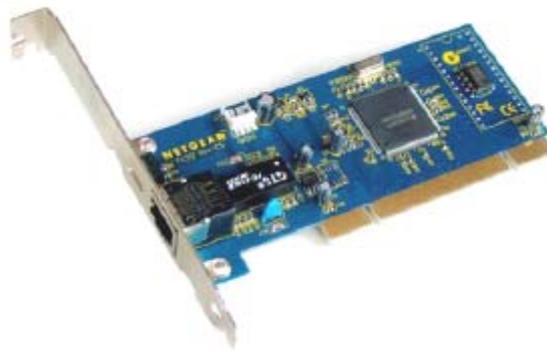
Die Netzkarte besitzt meist zwei Kontrollleuchtdioden (LEDs): Die grüne LED entspricht der Stromversorgung der Karte.
