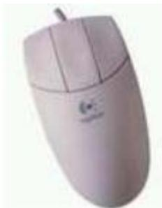
Die mechanische Maus enthält eine Kugel auf der sich 2 Rollen drehen. Diese Rollen enthalten jeweils ein Zahnrad, welches sich zwischen einer Fotodiode und einer LED (Leuchtdiode) dreht, und so das Licht sequenzweise durchlässt. Wenn das Licht durchgelassen wird, sendet die Fotodiode 1 Bit (1), wenn es auf ein Hindernis stößt, sendet die Fotodiode ein 0 Bit (0).
