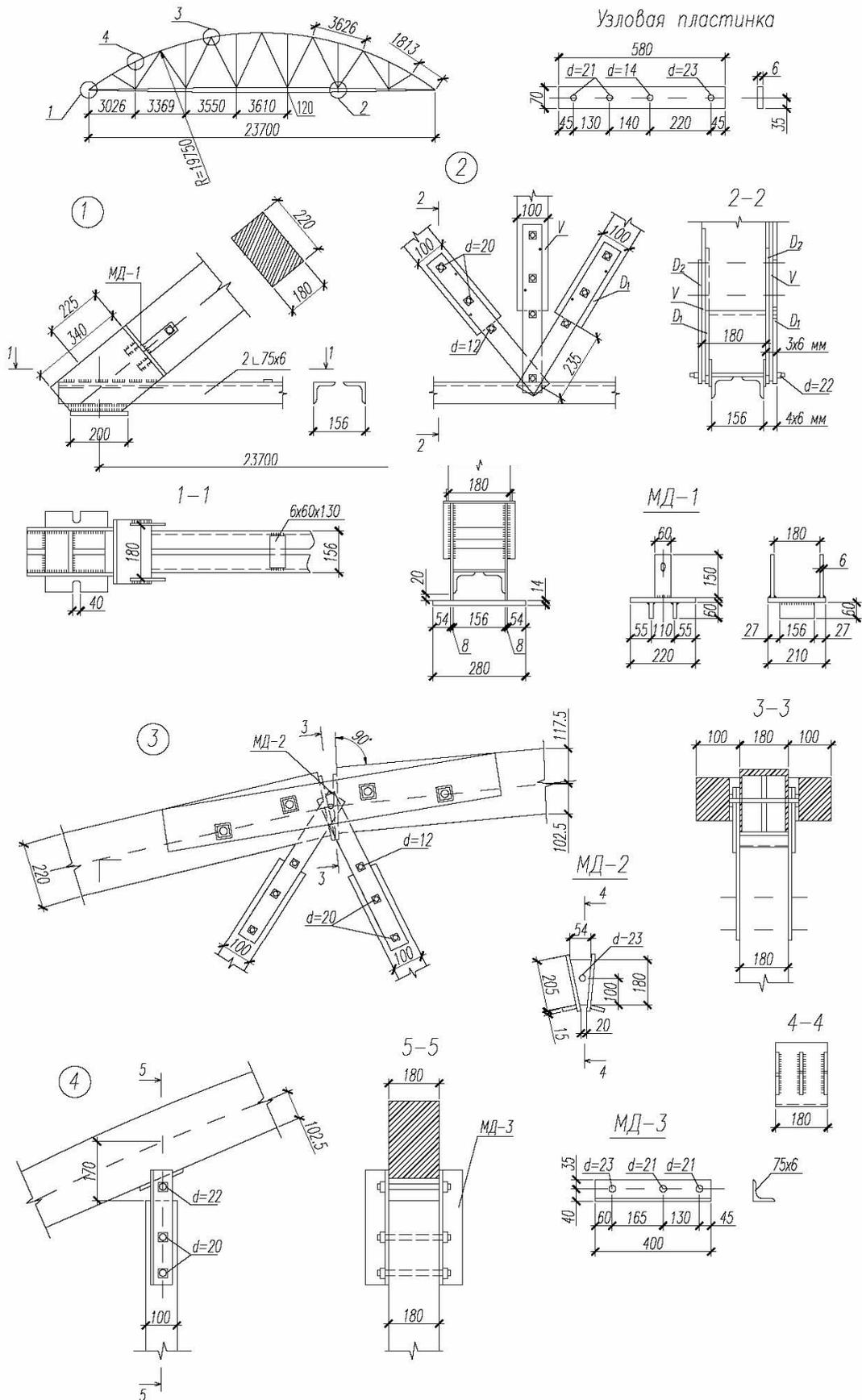
Рис. 5.6. Многоугольная брусчатая ферма ЦНИИСК пролетом 23,7 м
