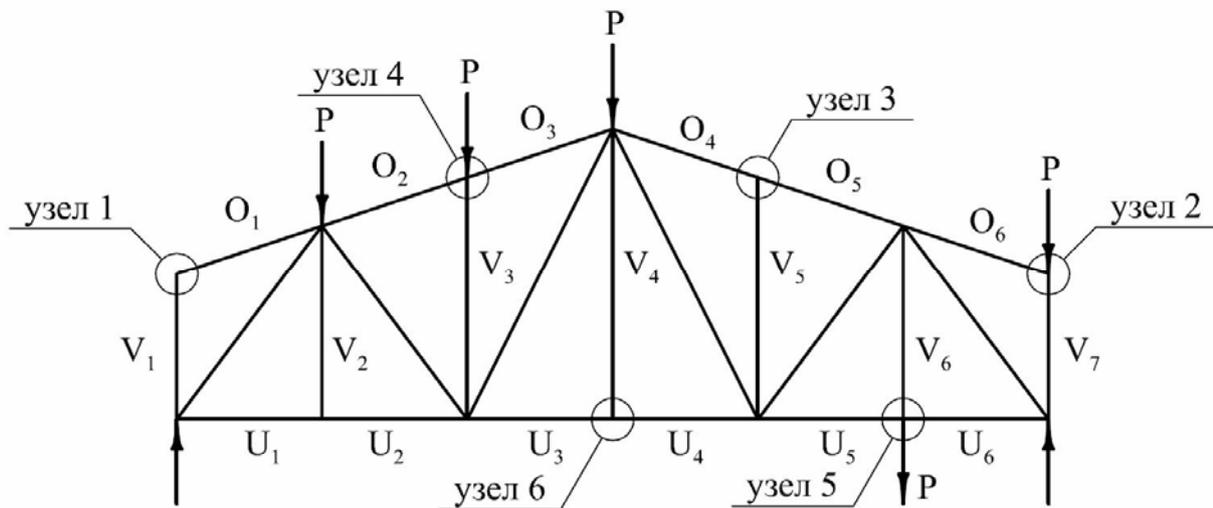
Рис. 2.7. К определению усилий в стержнях фермы
