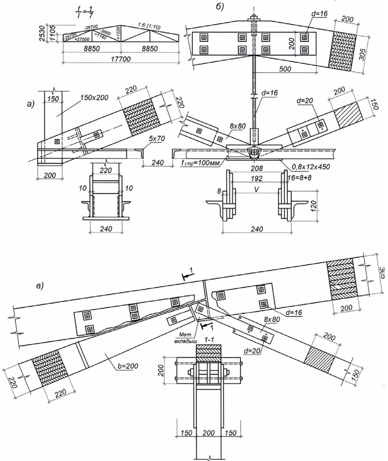
Рис. 5.10. Клееная трапециевидная ферма пролетом 17,7 м со сжатым опорным раскосом:
