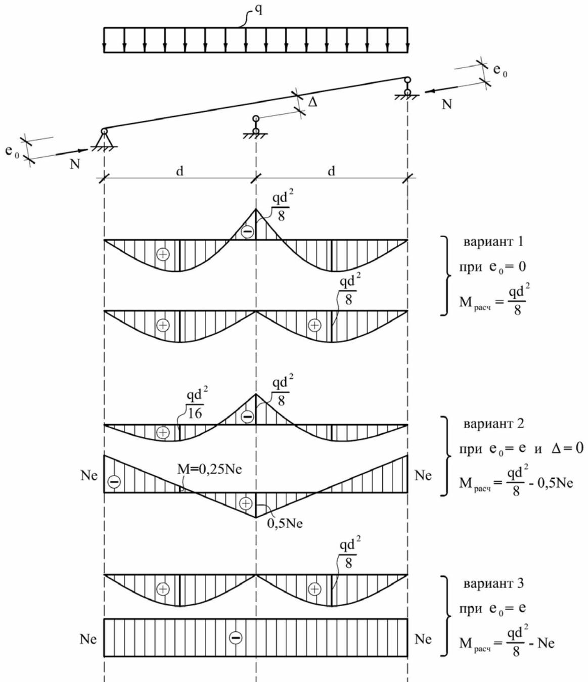
Рис. 5.7. К расчёту верхнего пояса многоугольной фермы
