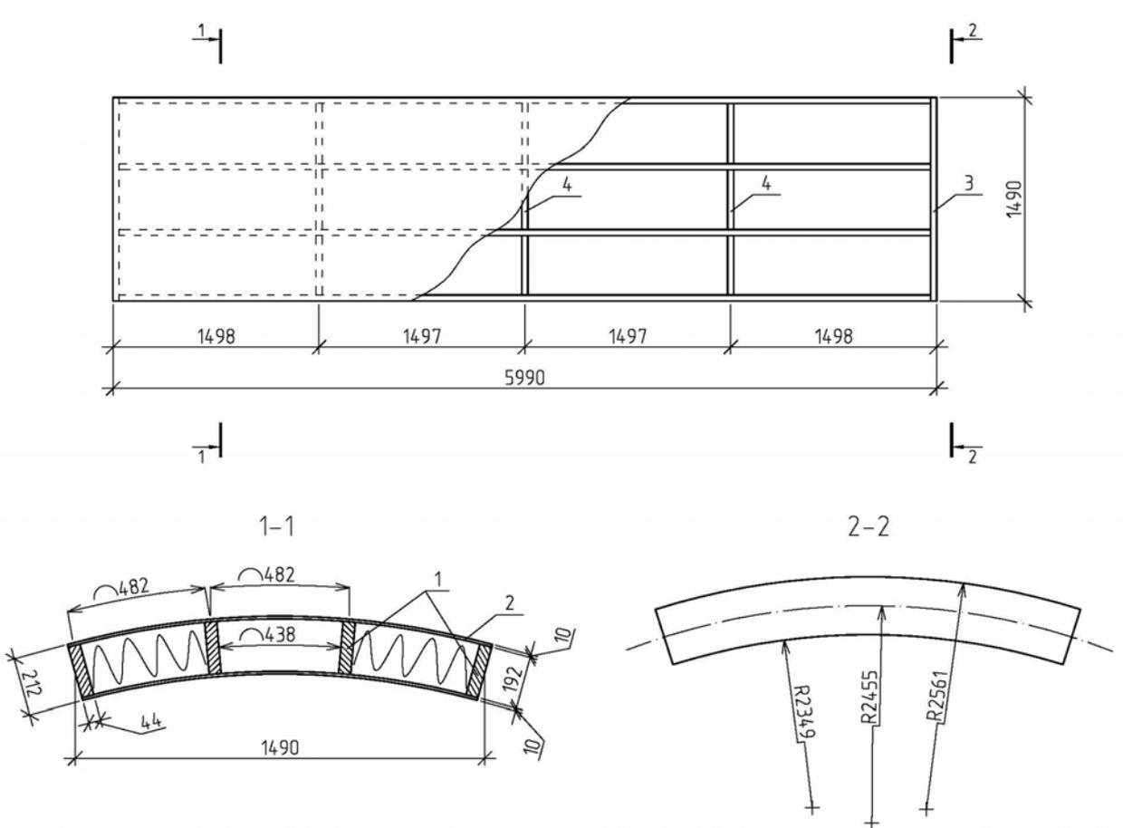
Рис. 6.2. Клеефанерная панель покрытия:
