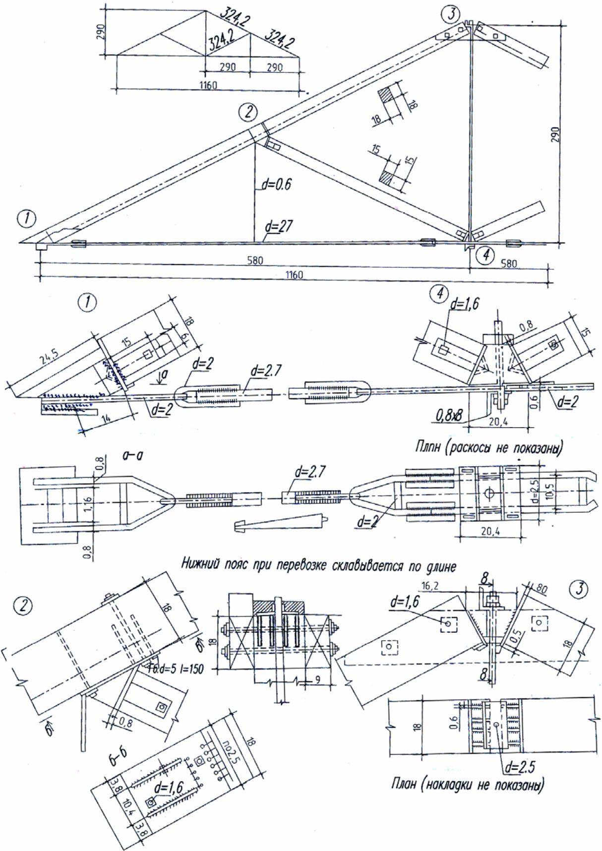
Рис. 5.4. Брусчатая ферма ЦНИИСК пролетом 11,6 м
