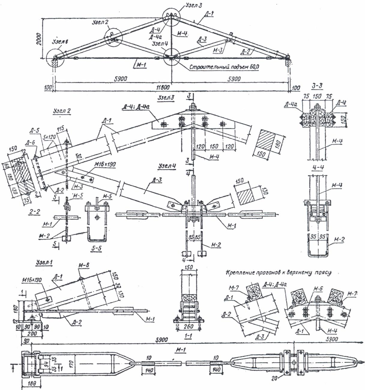
Рис. 5.3. Брусчатая ферма пролетом 11,8 м с подвесным потолком и со складывающимся в перевозке нижним поясом
