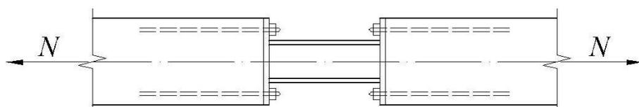
Рис. 4.13. Соединения деревянных элементов с применением клеенных стержней:
