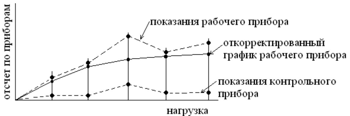
Схема «время – нагрузка – деформация»
