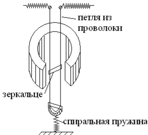
Вибратор представляет собой вертикальную петлю из тонкой проволоки, на которой укреплено легкое зеркальце. Петля натягивается спиральной пружиной и помещается вместе с зеркальцем между полюсами подковообразного магнита. Для уменьшения собственных колебаний петли вся система, заключается в корпусе и заливается специальной жидкостью.
