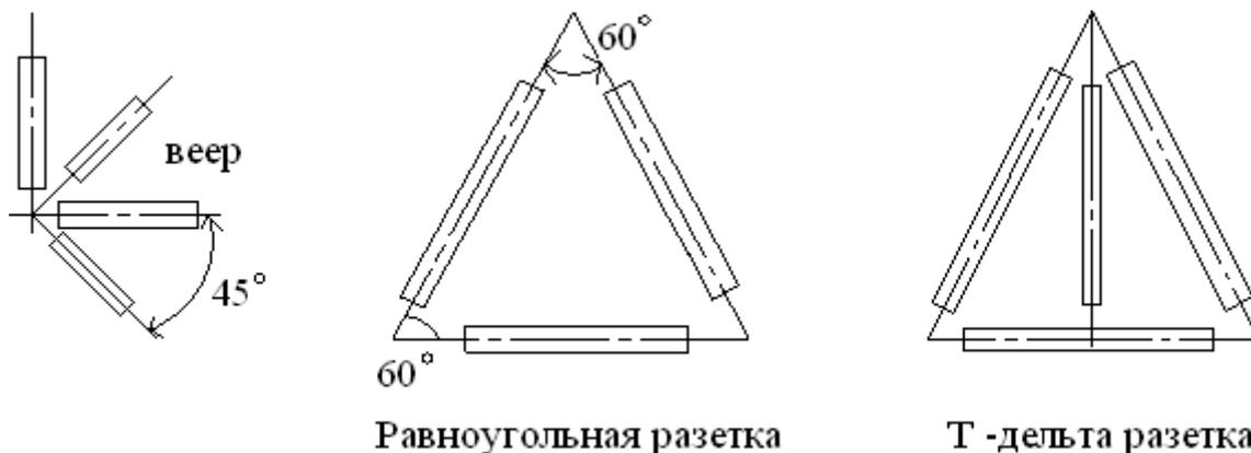
Ввиду небольших размеров тензорезисторов размещение их на поверхности конструкций обычно не вызывает затруднений. В очень стесненных условиях пользуются розетками с совмещенными тензорезисторами наклеенными на одну основу.
