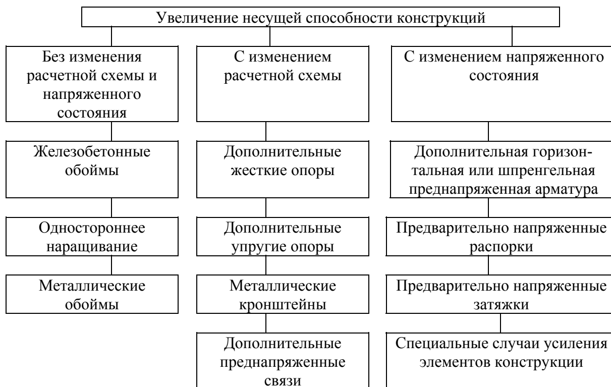
Рис. 2.1. Методы увеличения несущей способности железобетонных конструкций
