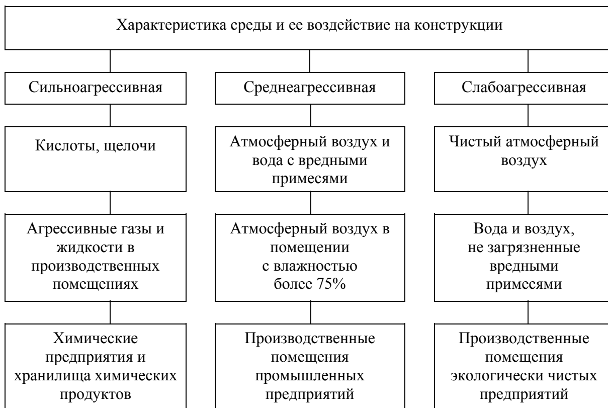
Рис.1.4. Характеристики среды и ее воздействие на конструкции
