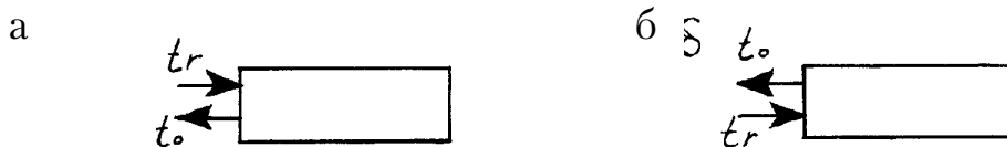
Рис. 3.2. Схема присоединения отопительных приборов к стояку: а – подача теплоносителя сверху вниз; б – подача теплоносителя снизу вверх
