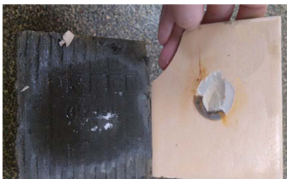
Рис. 4.6. Прочность сцепления с цементно-песчаной подложкой после выдерживания в водной среде
