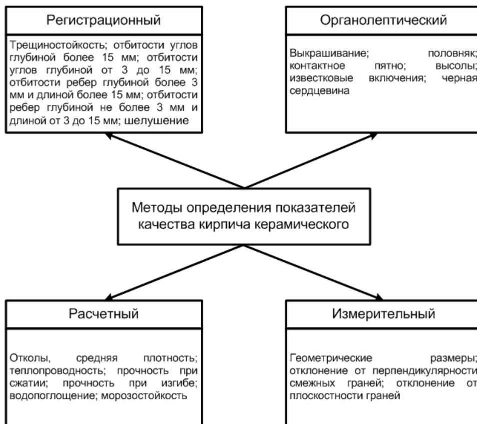
Рис. II. Методы определения показателей качества кирпича керамического
