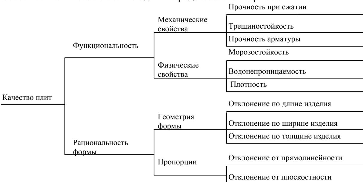
Рис. 3. Дерево свойств для железобетонных плит балконов и лоджий
