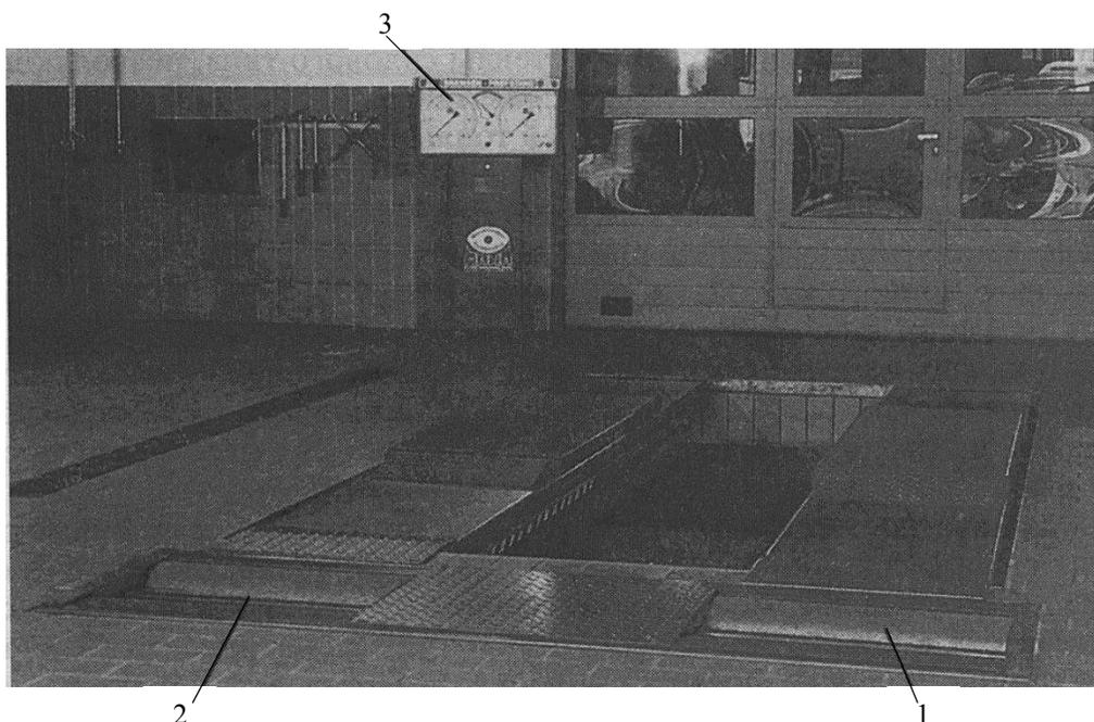
Рис. 5.2. Роликовый тормозной стенд силового типа:
