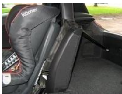
автокресло с креплением изофикс и якорным ремнем
