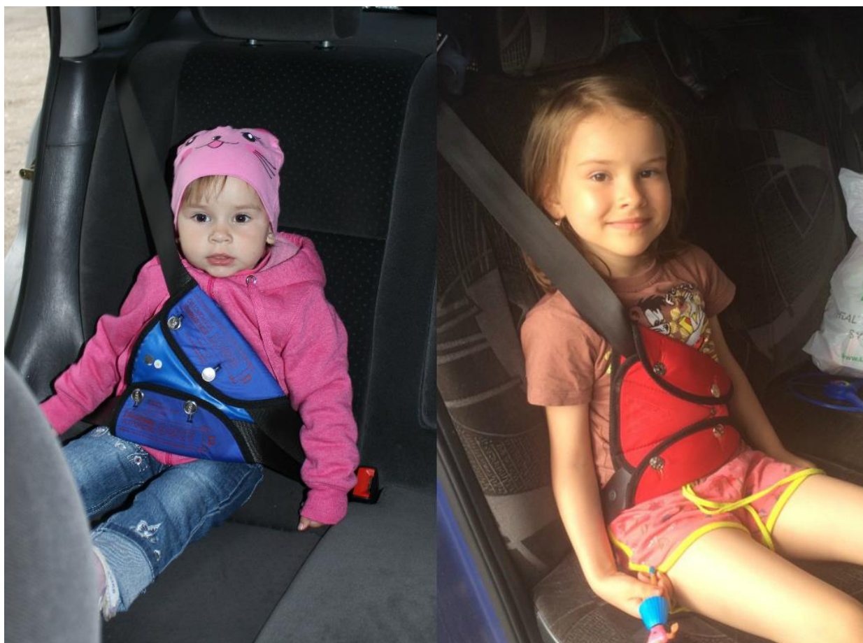
Рис. 4.5 Фотография детей 2-х летнего и 6-ти летнего возраста, пристегнутых с помощью треугольного адаптера.
