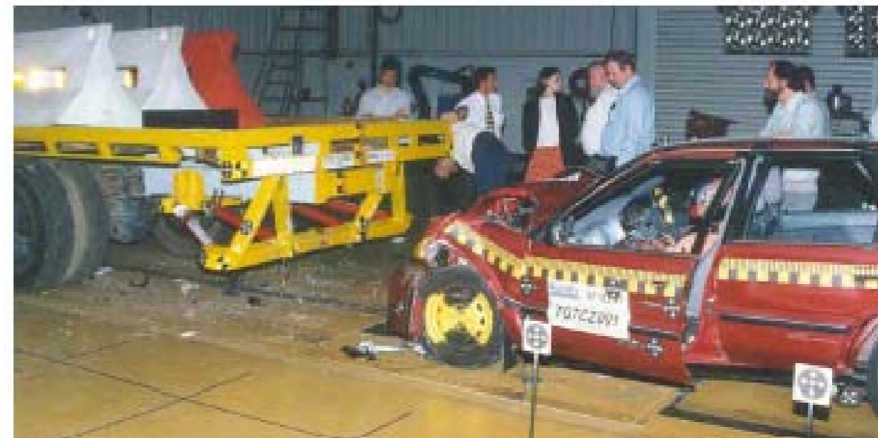
Результаты краш-теста усовершенствованного ЗЗУ
