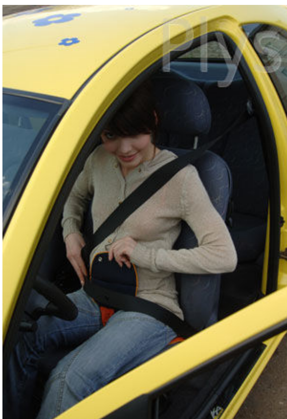
Рис. 2.13 Фиксация адаптера ремня безопасности
