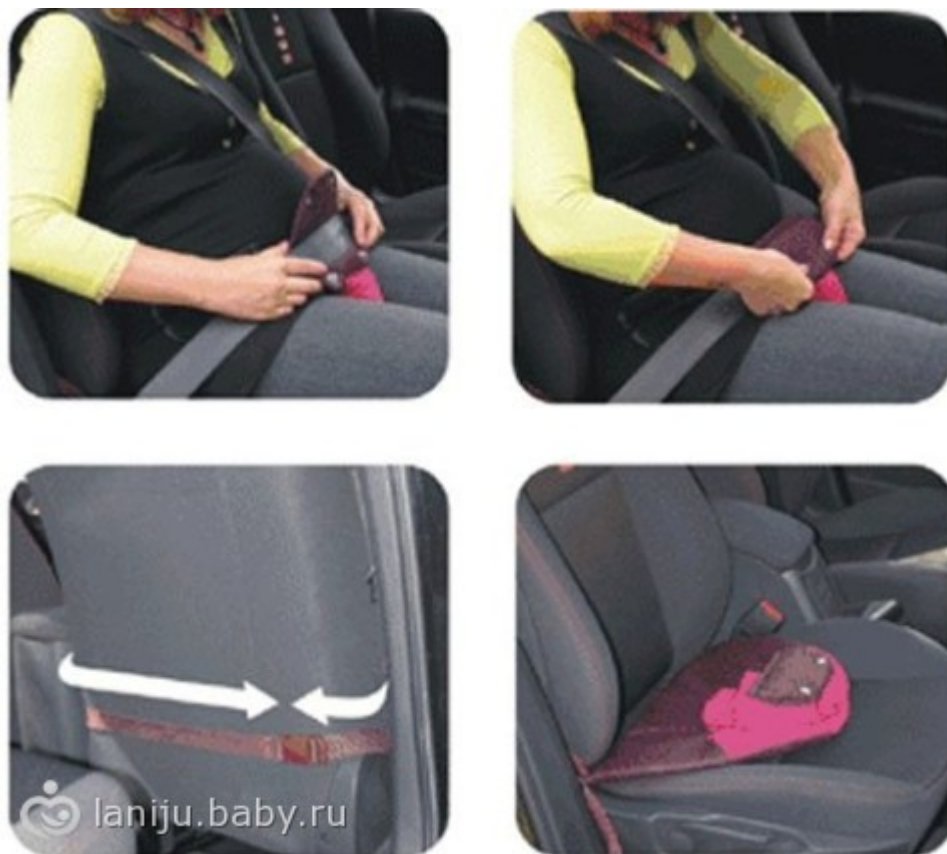
Рис. 2.14 Фиксация адаптера ремня безопасности
