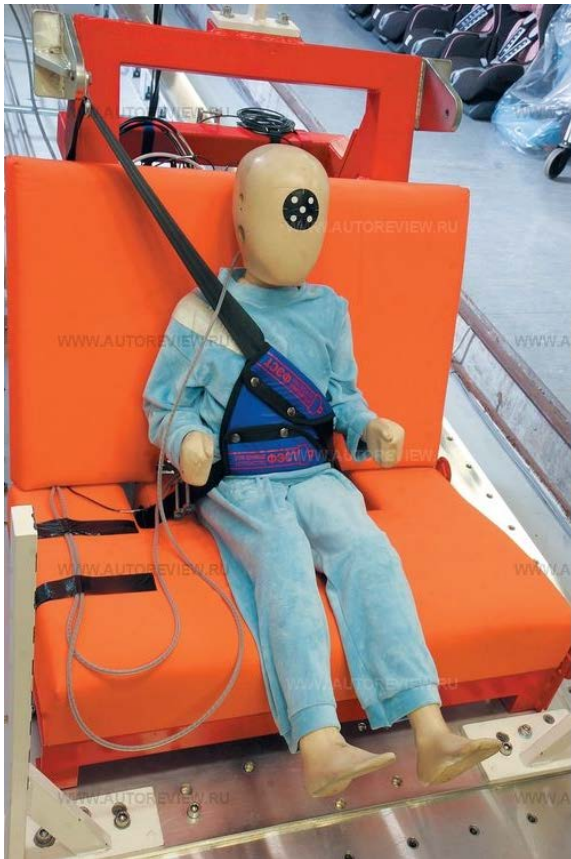
Рис. 2.4. Адаптер на кнопках ФЭСТ
