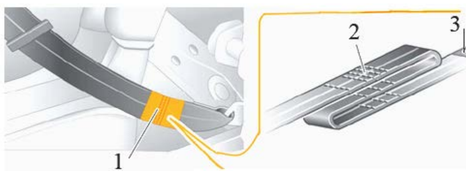
Рис. 1.16 Петлеобразный прошитый ремень безопасности: 1 – прошитая зона ремня безопасности; 2 – швы; 3 – зажим ремня
