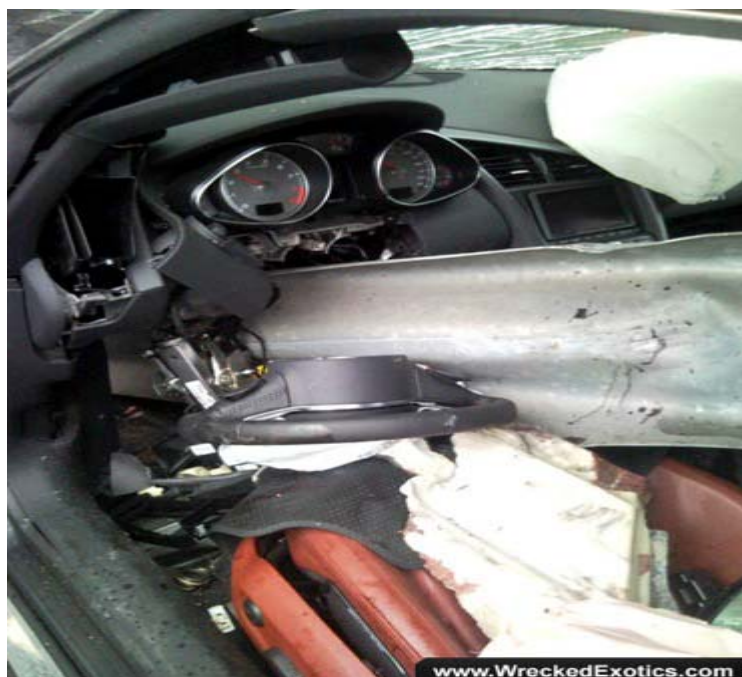
Рисунок 27- Пример вхождения ограждения в автомобиль
