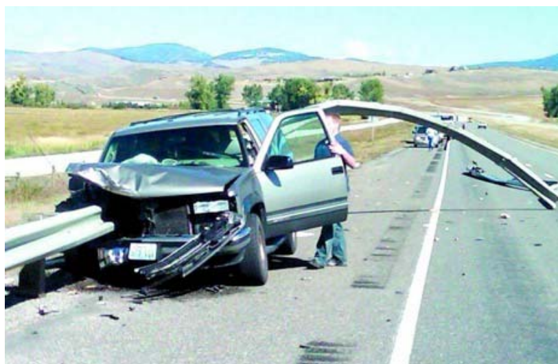
Рисунок 26- Пример вхождения ограждения в автомобиль
