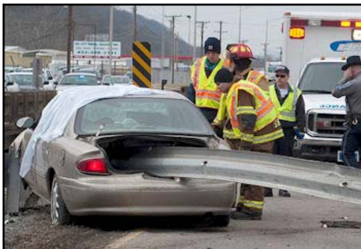
Рисунок 1- Последствие столкновения автомобиля с дорожным ограждением
