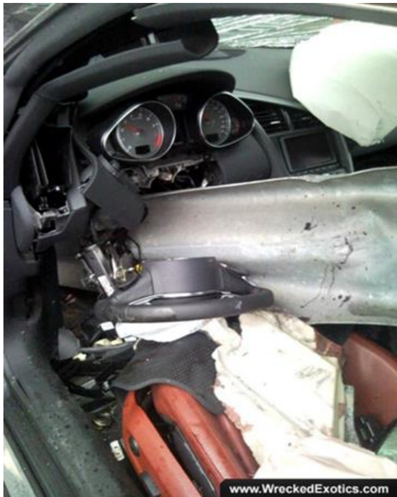
Последствия столкновения ТС с ограждением без буферного элемента
