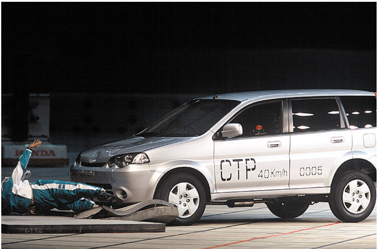
Рис. 1.2. Кинематика наезда автомобиля на пешехода
