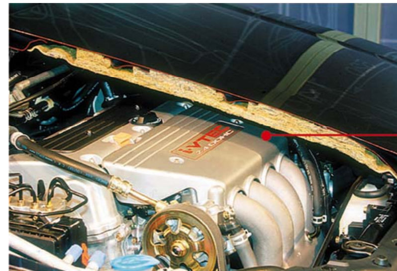
Поперечный брус утоплен в глубь передка
