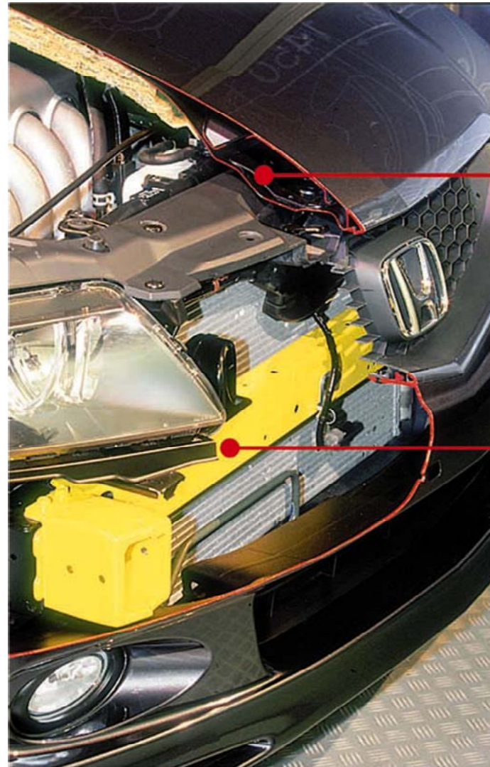
«Мягкая» передняя кромка капота
