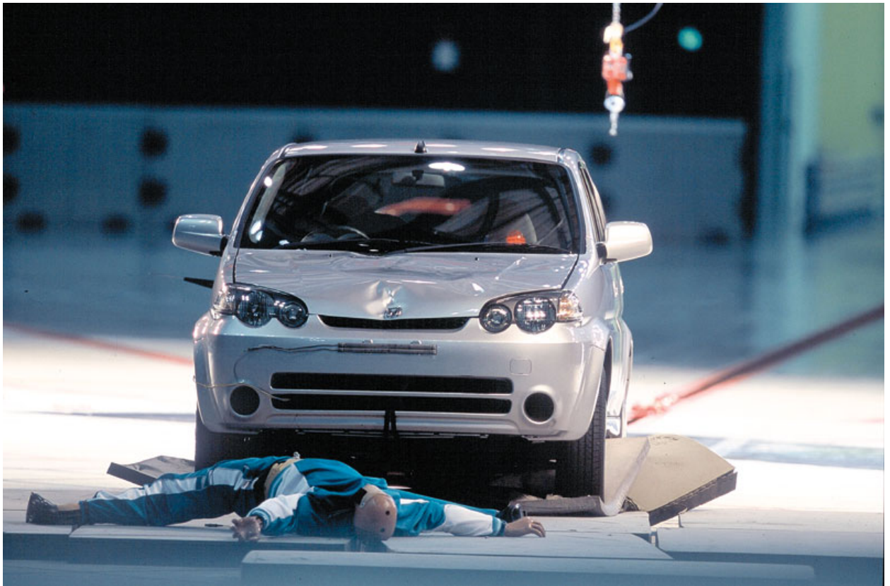
Рис. 1.4. Удар коленями приходится на самую выступающую часть бампера, а удар головой происходит о капот в районе стыка с лобовым стеклом
