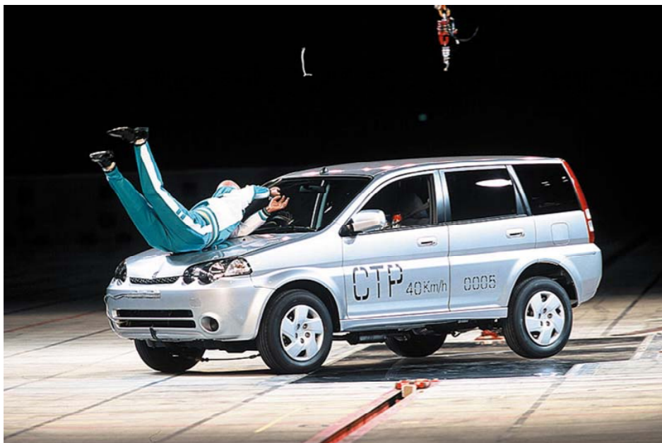
Схема наезда автомобиля на пешехода
