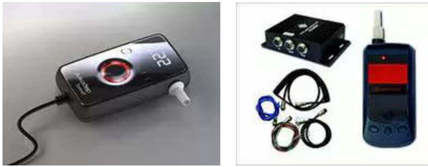
Рисунок 4.1 – Внешний вид алкозамка
