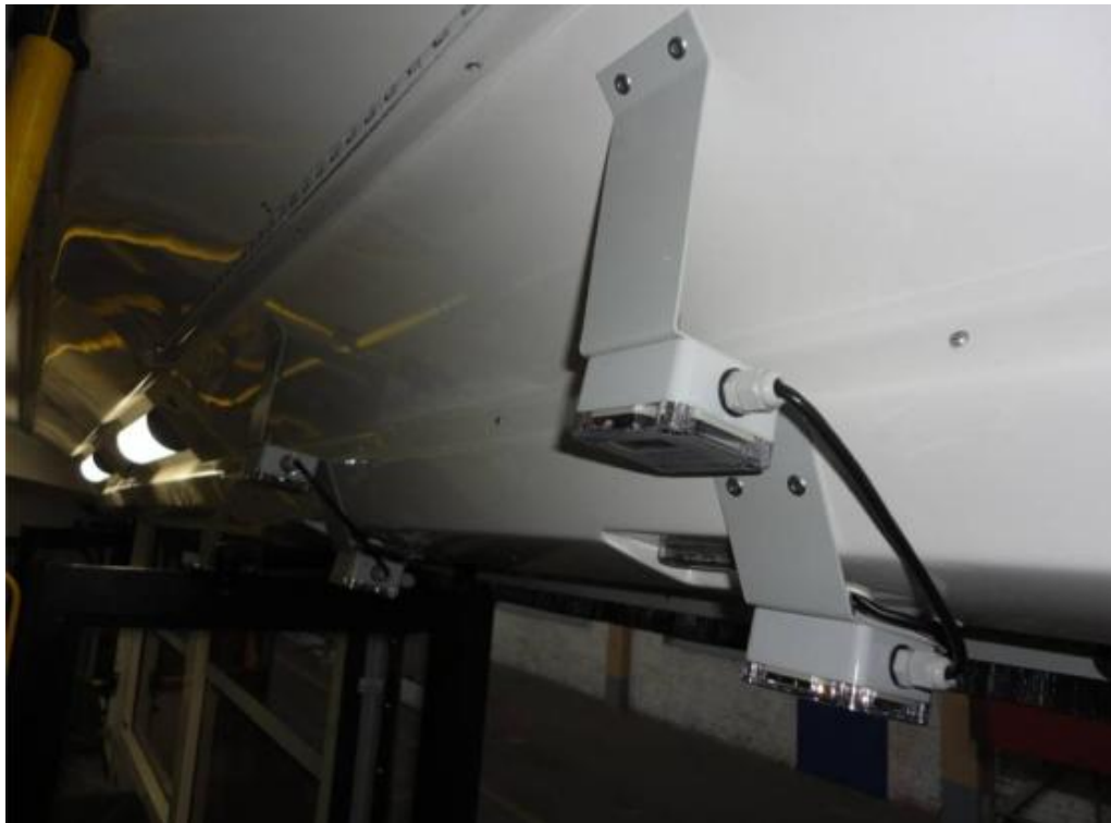
Рис.3.11. Установка на двухстворчатую дверь троллейбуса ТролЗа ИК-датчиков «Луч-МС»
