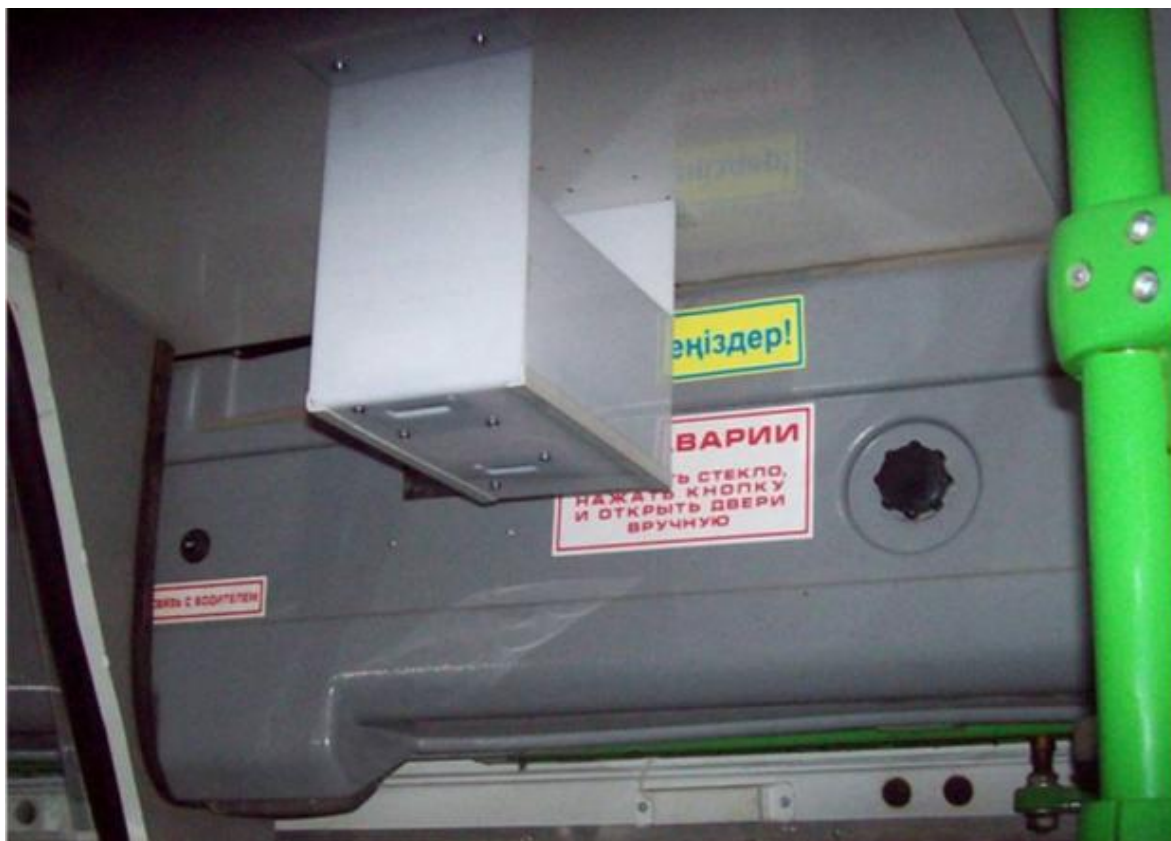
Рис.3.9. Установка на одностворчатую дверь автобуса ЛиАЗ ИК-датчика «Луч-МС»
