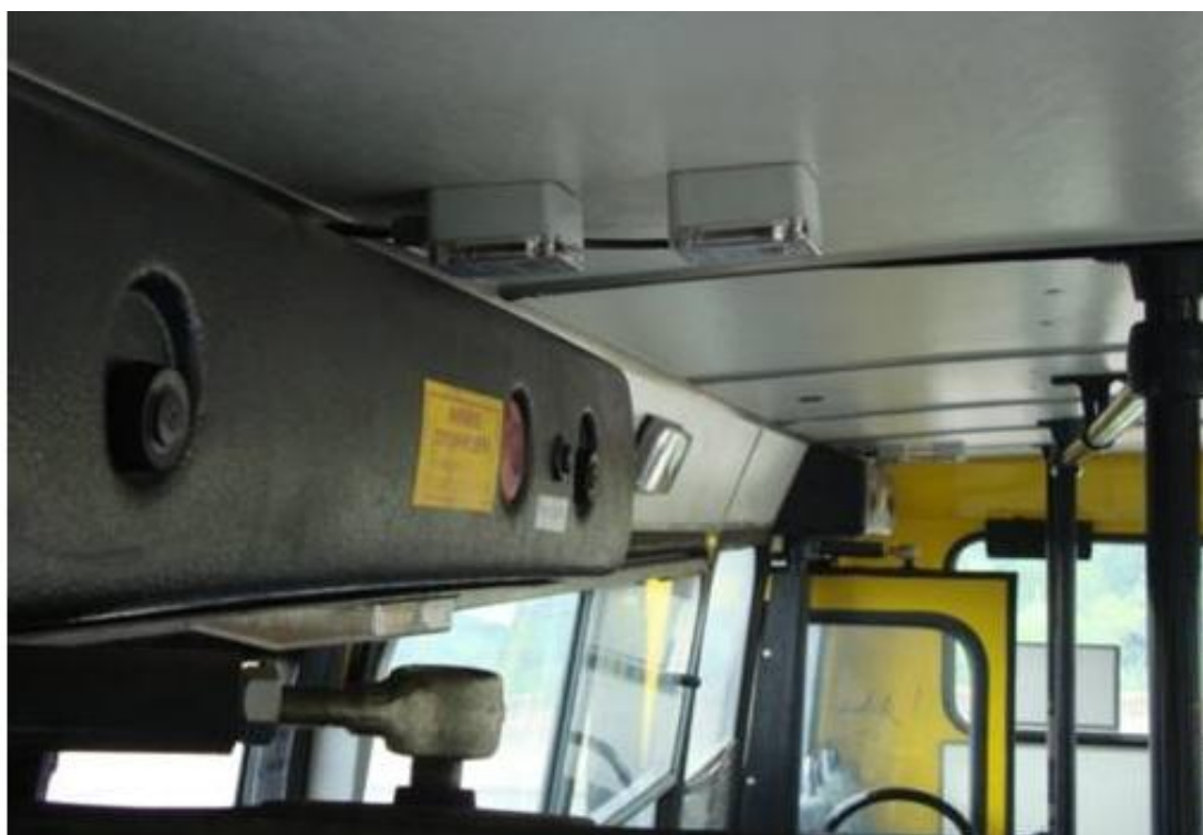
Рис.3.10. Установка на одностворчатую дверь автобуса Богдан ИК-датчика «Луч-МС»
