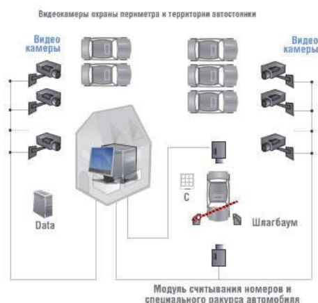
Рис 2. 22 Видеонаблюдение с функцией автоматической регистрации автомобиля
