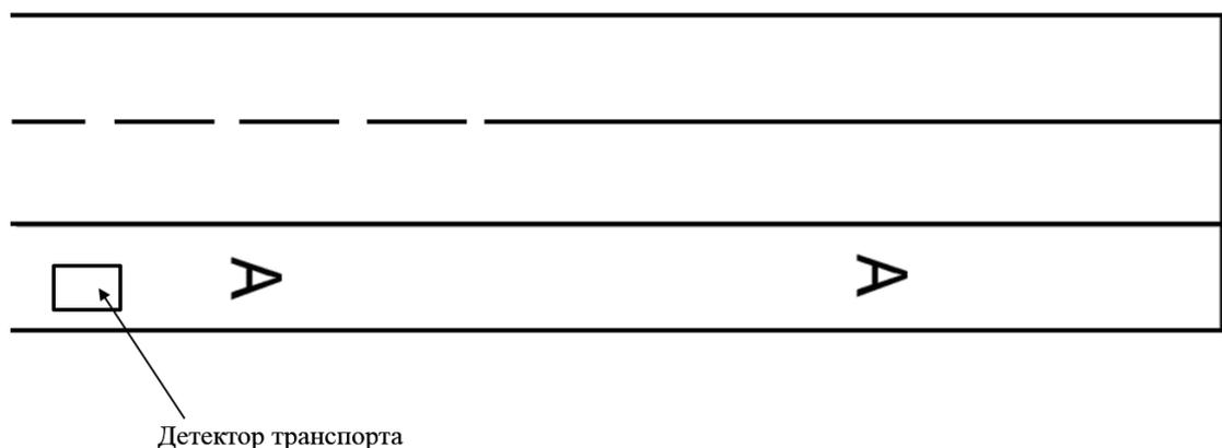
Рисунок 5 Схема установки детектора транспорта
