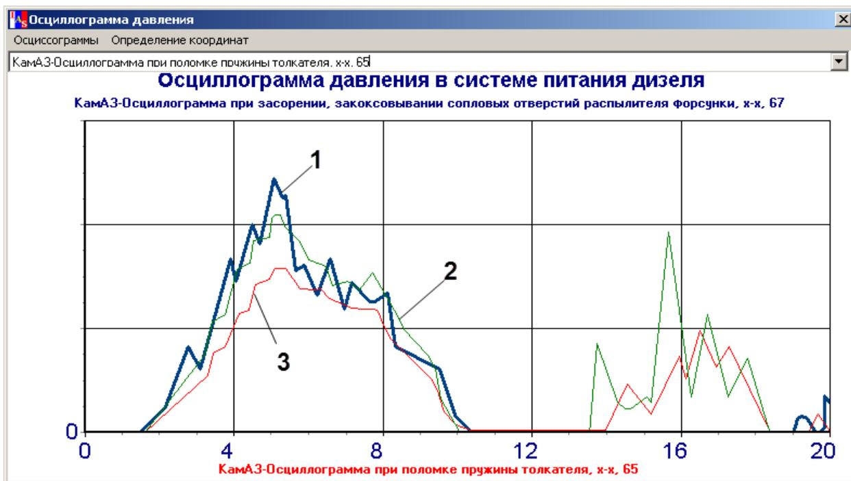
Рисунок 2.3 - Окно с осциллограммами комплекса КАД-400
