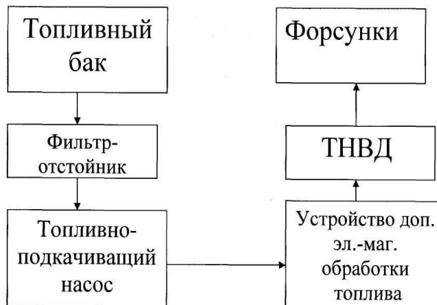
Рисунок 2.7 – Схема установки устройства в топливную систему дизеля
