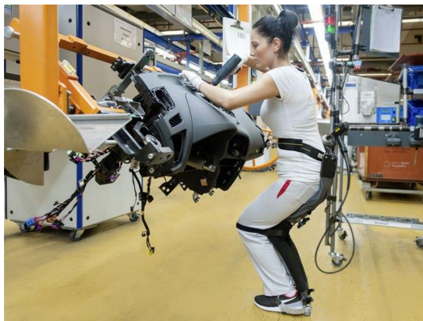
Рис.3.3. Промышленный экзоскелет нижних конечностей, Chairless Chair, Noonee, Audi, Швейцария-Германия, 2015 г.
