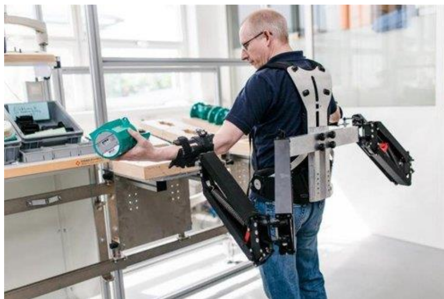
Рис.3.2. Пассивный экзоскелет верхних конечностей Robo-Mate, Европейский союз, 2015 г.
