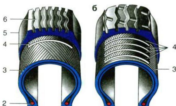
Рис. 1.3 Конструкция диагональной (а) и радиальной (б) шины: 1-борта; 2-бортовая проволока; 3-каркас; 4-брекер; 5-боковина; 6-протектор.
