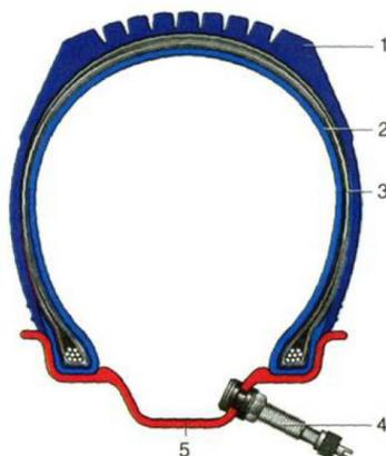
Рис.1.2 Бескамерная шина: 1-протектор;
