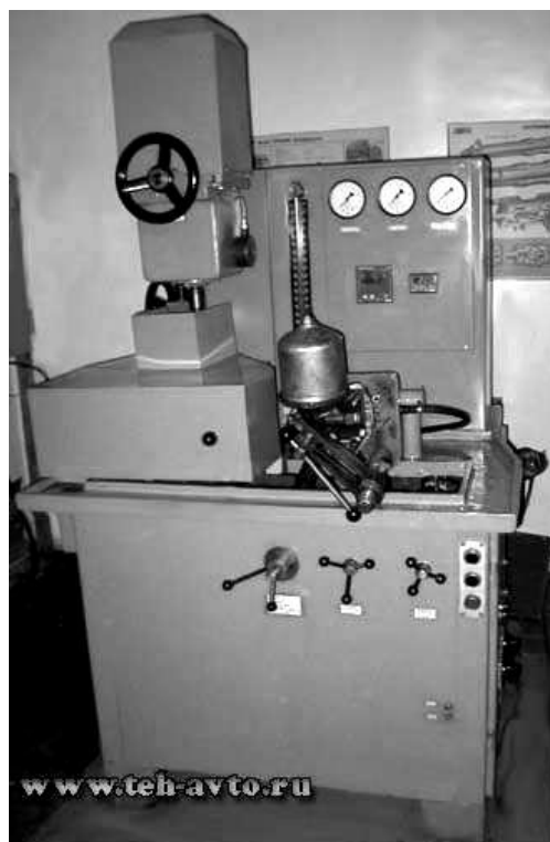
Рис. 3.2 Стенд для испытания масляных насосов и корпуса фильтров ДВС КИ-28199
