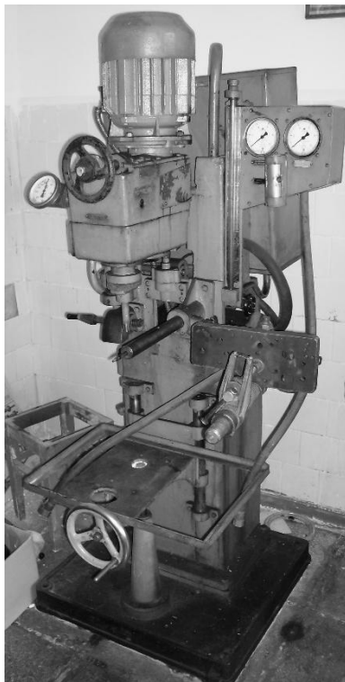
Рис.3.6. Стенд испытания масляных насосов и масляных фильтров автотракторных двигателей КИ–1575
