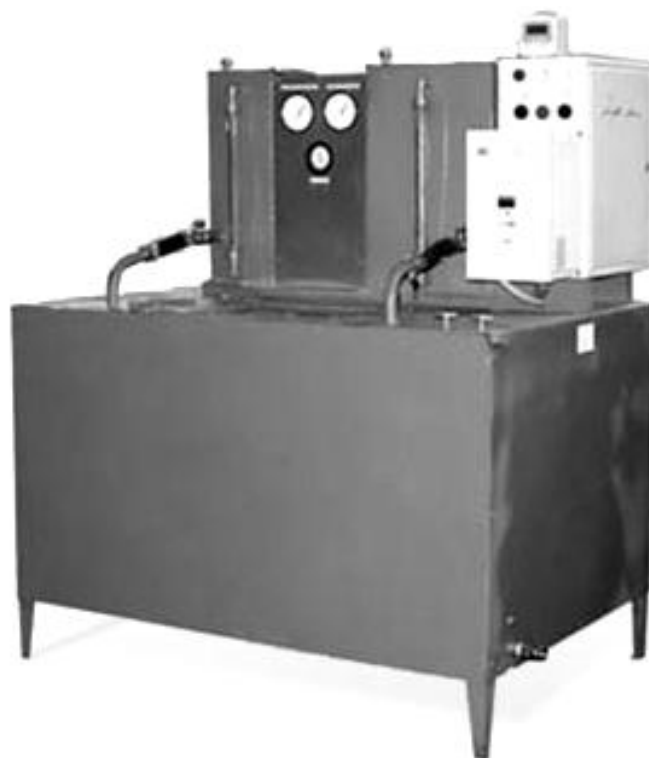
Рис.3.1 Стенд для испытания масляных насосов СПМ-236У
