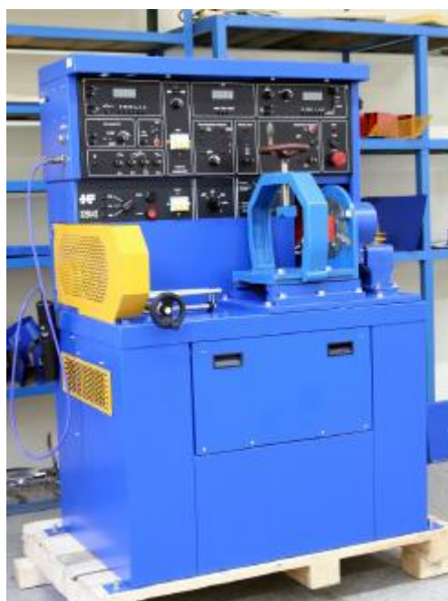
Рис. 3.4 Стенд проверки электрооборудования Э-250-02
