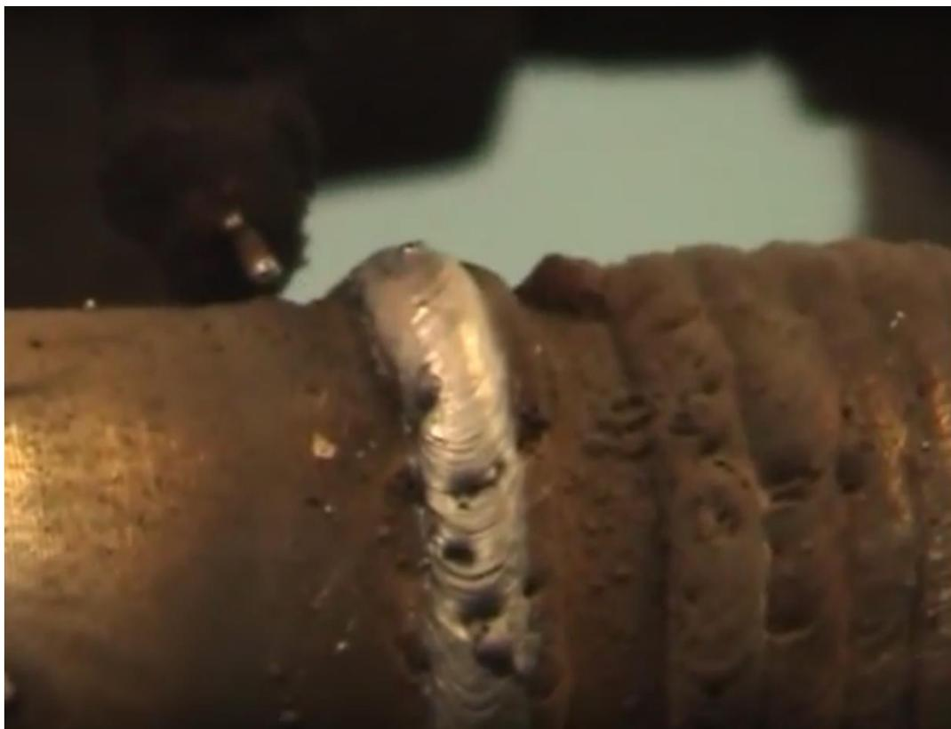
Рис. 1.4 Вибродуговая наплавка
