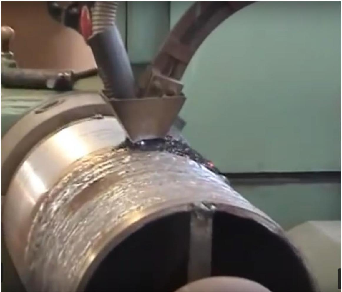
Рис. 1.5 Электрошлаковая наплавка
