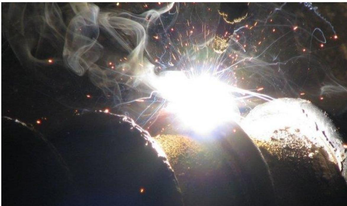
Рис. 1.3 Электродуговой метод наплавки
