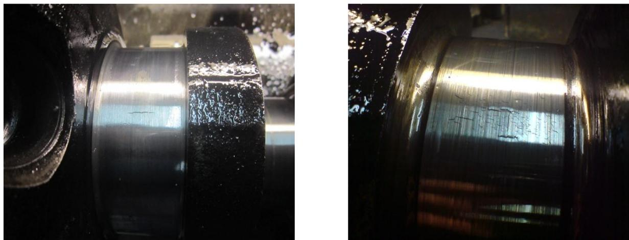
Рис. 1.4. Усталостные трещины на шейке вала
