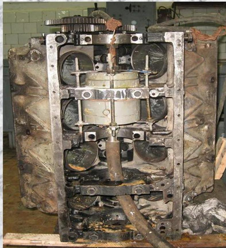
Внешний вид электролитической ячейки при осаждении электролитического железа на опоры блока цилиндров
