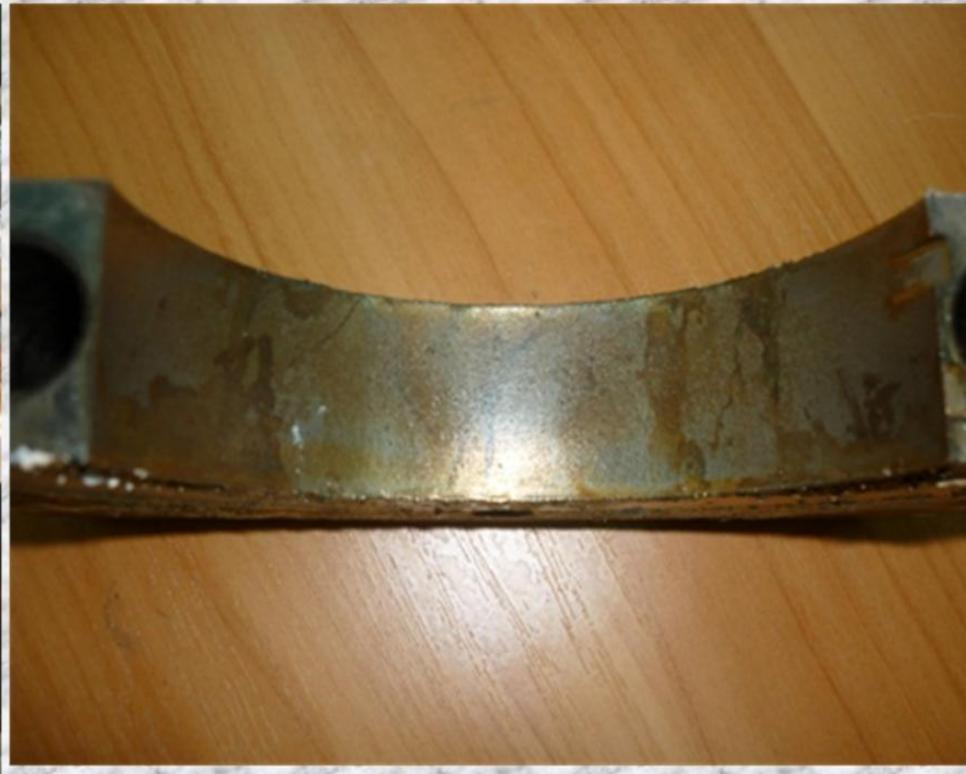
**Внешний вид покрытия электролитического железа, осажденного на коленчатого вала**
