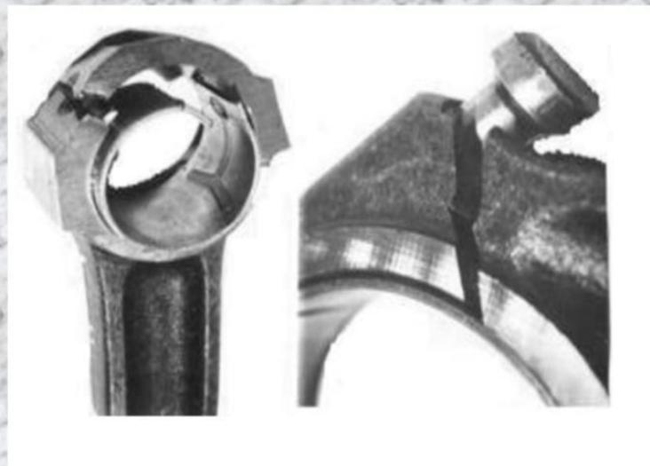
**Усталостные разрушения по верхней головке шатуна и цековке под головку блока**
