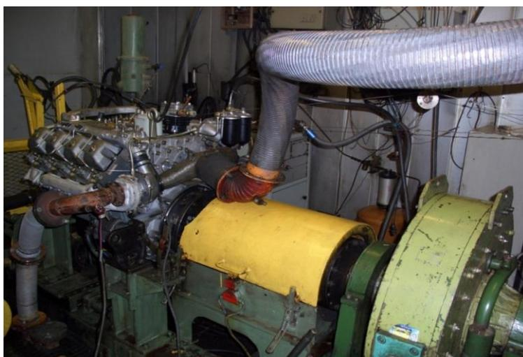
Рис. 2.6. Стенд для периодических испытаний двигателей КамАЗ
