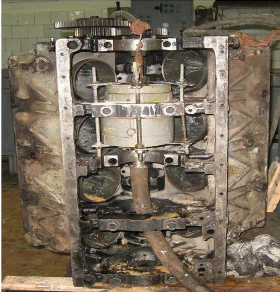
Рис. 4.16. Внешний вид электролитической ячейки при осаждении электролитического железа на опоры блока цилиндров
