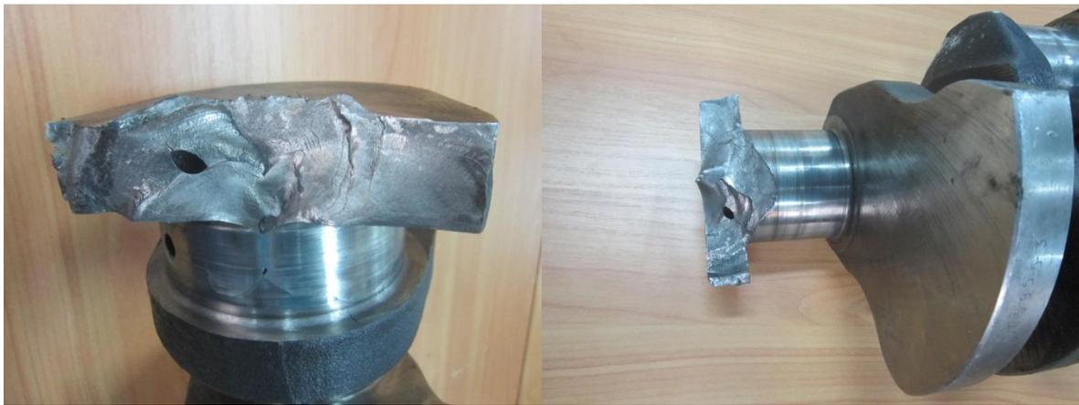
Рис. 3.15. Усталостное разрушение коленчатого вала
