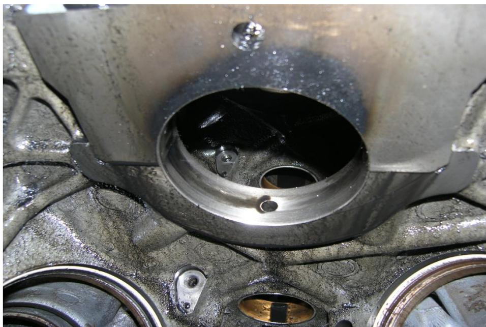
Рис. 1.6. Износ постели блока в результате перегрева сопряжения и проворачивания коренного подшипника
