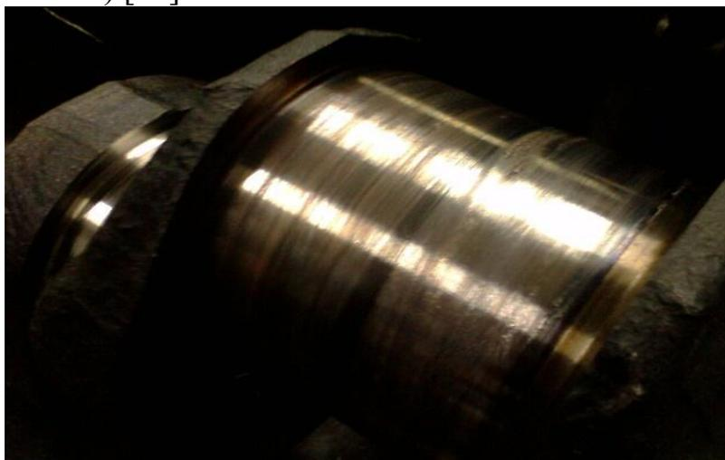
Рис. 3.20. Задиры шейки коленчатого вала
