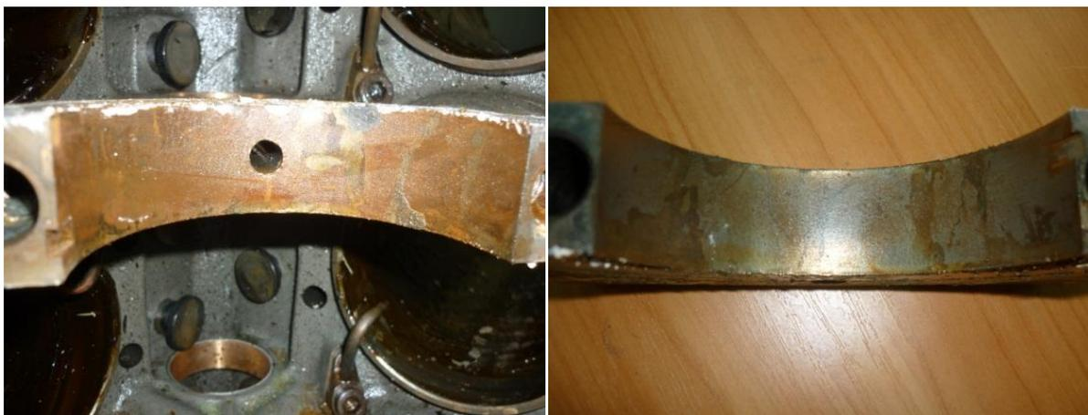
Рис. 4.17. Внешний вид покрытия электролитического железа, осажденного на опоры блока цилиндров
