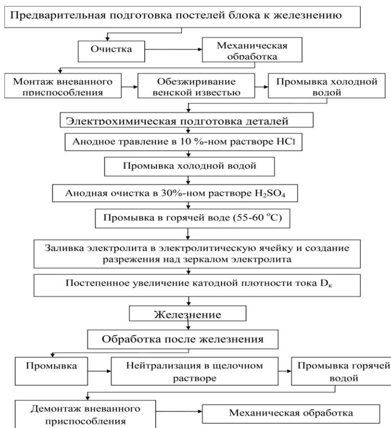
Рис. 4.14. Схема технологического процесса вневанного железнения опор блока цилиндров двигателя КамАЗ
