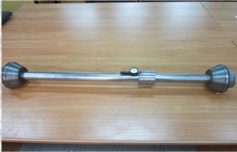
**Прибор для измерения соосности постелей блока двигателя**
