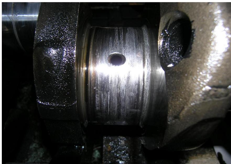
Рис. 1.3. Задир на шейке вала, результат схватывания с вкладышем
