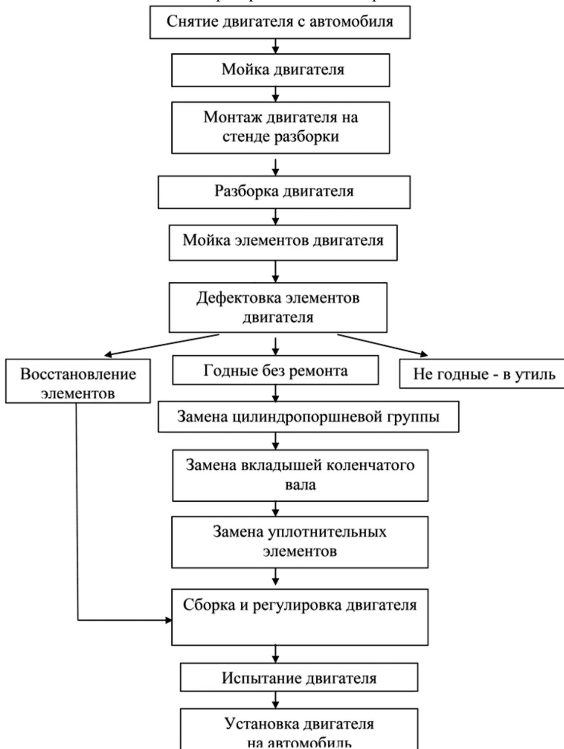
Рис. 5.2. Схема ремонта двигателя КамАЗ-Евро
