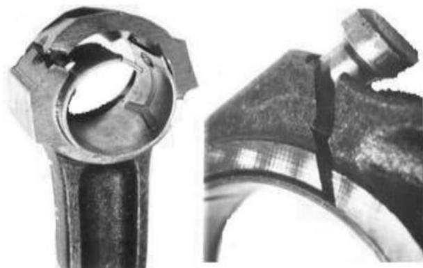
Рис.1.9. Усталостные разрушения по верхней головке шатуна и цековке под головку блока
