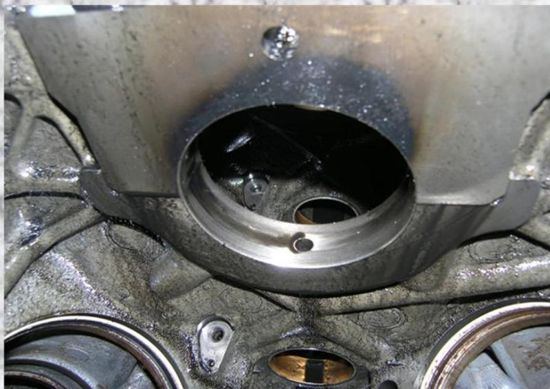
**Износ постели блока в результате перегрева сопряжения**
