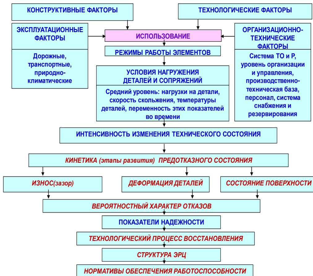
Рис. 3.1. Схема причинно-следственной связи факторов и нормативов технической эксплуатации автомобилей
