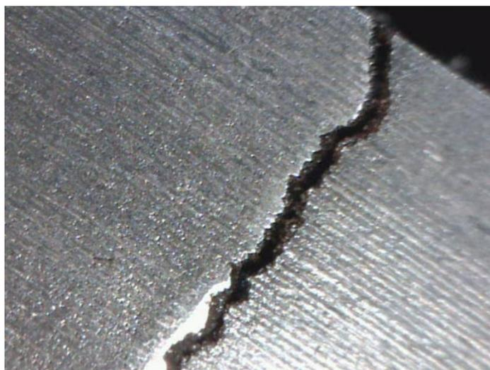
Рис. 3.25. Трещина в опоре блока (фотография сделана с микроскопа Webers W2C  $\times 200$ )
