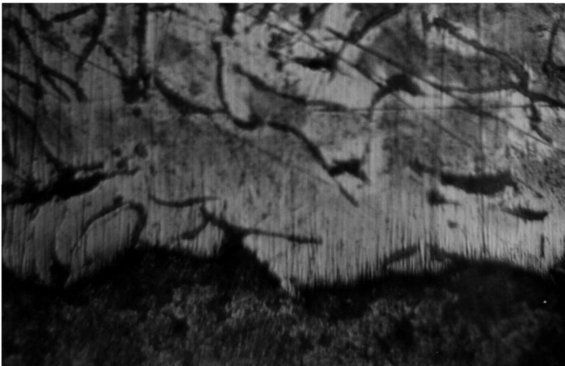
Рис. 3.7. Граничная зона между чугуном СЧ 18 и цинковым гальванопокрытием ( $\times 400$ )
