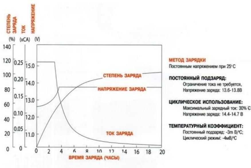
Рисунок 1.1.4 - Зарядная характеристика AGM АКБ
