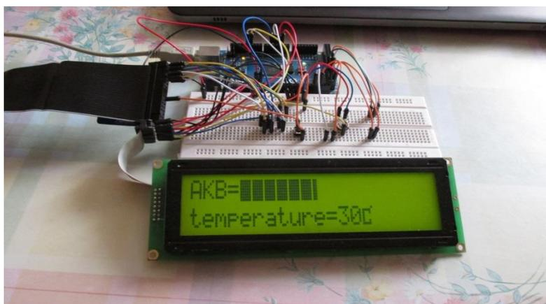
Рисунок 4.3.7 - Показания приборов температуры окружающей среды, расчетный заряд аккумуляторной батареи
