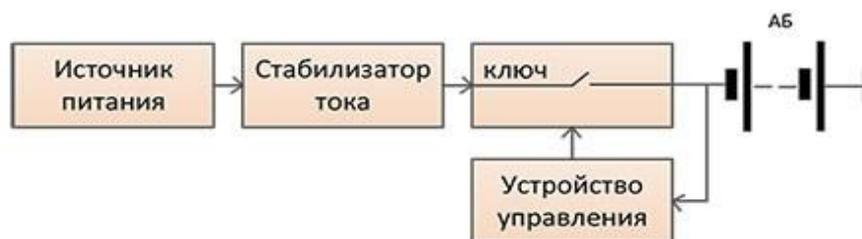
Рисунок 3.1.2 - схема зарядки АКБ стабилизированным током
