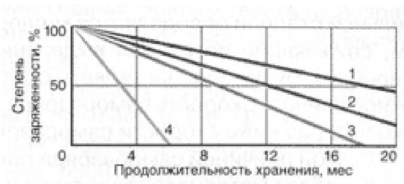
Рисунок 3.1.7 - Изменение уровня заряженности автомобильных аккумуляторов различных конструкций при хранении: 1 - аккумуляторы со свинцово-кальциевыми сплавами, 2 - гибридные аккумуляторы, 3 - аккумуляторы с малосурьмяными сплавами, 4 - аккумуляторы традиционного исполнения
