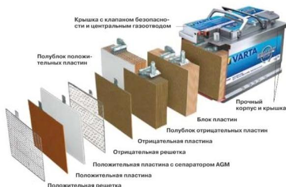
Рис. 1.1.1 - Свинцово-кислотный аккумулятор технологии AGM
