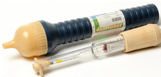
Рисунок 4.3.3 – Ареометр автомобильный
