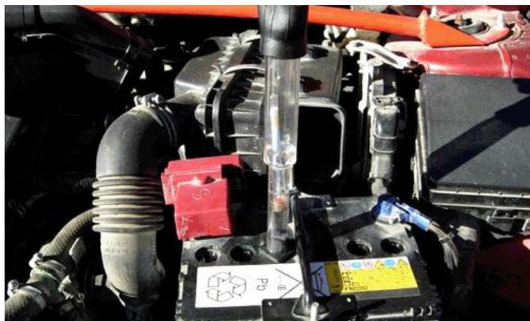
Рисунок 4.3.12 - Измерение плотности вручную
