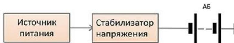
Рисунок 3.1.3 - Схема зарядки АКБ стабилизированным напряжением
